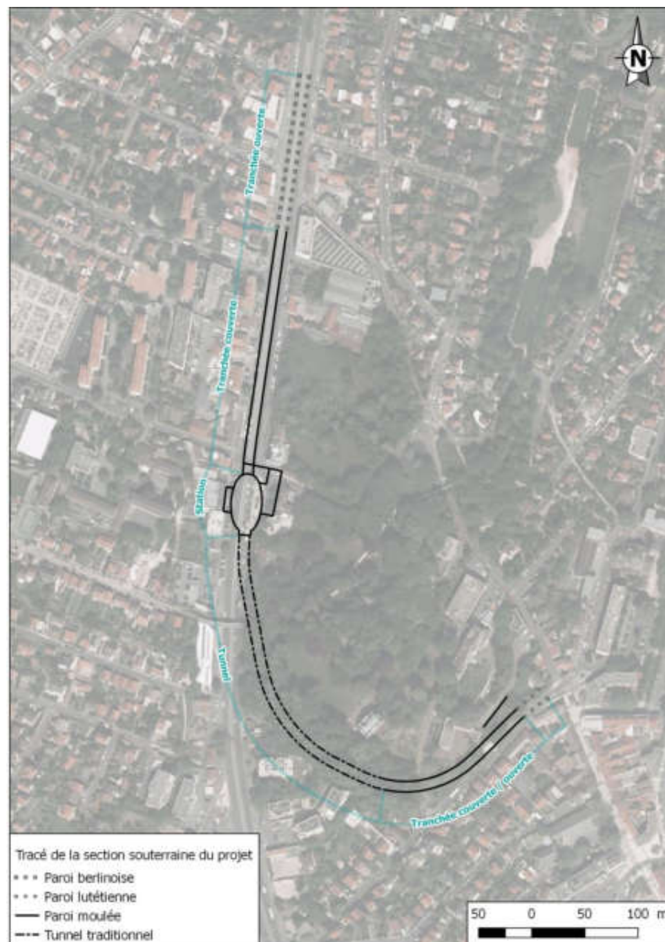
Figure 10 : Localisation des différentes méthodes constructives le long du tracé de la section souterraine du projet (fond : BD ORTHO® IGN)
