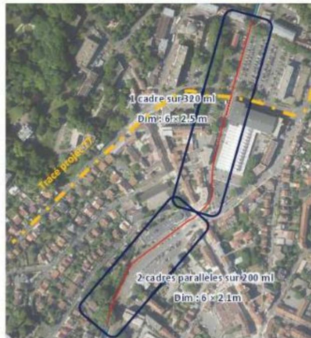
DÉFINITION DE L'IMPACT DE LA MODIFICATION DE SECTION DE L'OUVRAGE HYDRAULIQUE DE L'ORGE AU DROIT DU PROJET DU PROLONGEMENT DU TRAM T7
