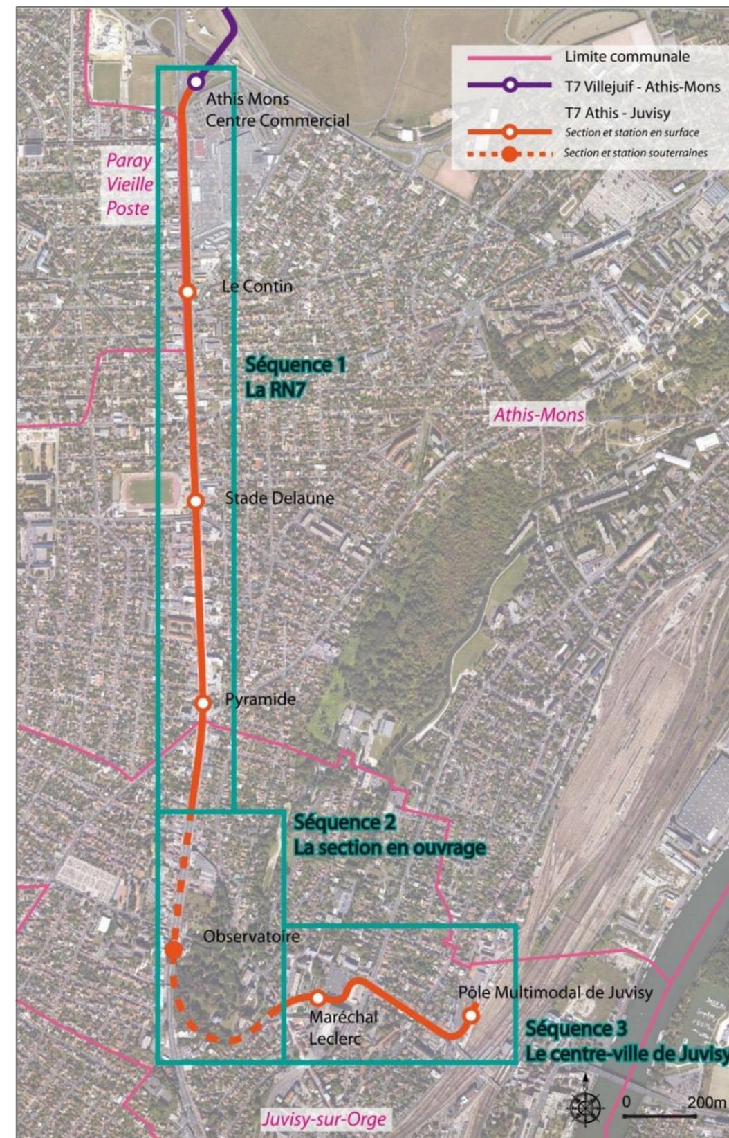
Figure 2 : Tracé et interstations du projet de tramway T7 Athis – Juvisy (Source photo aérienne : InterAtlas)
