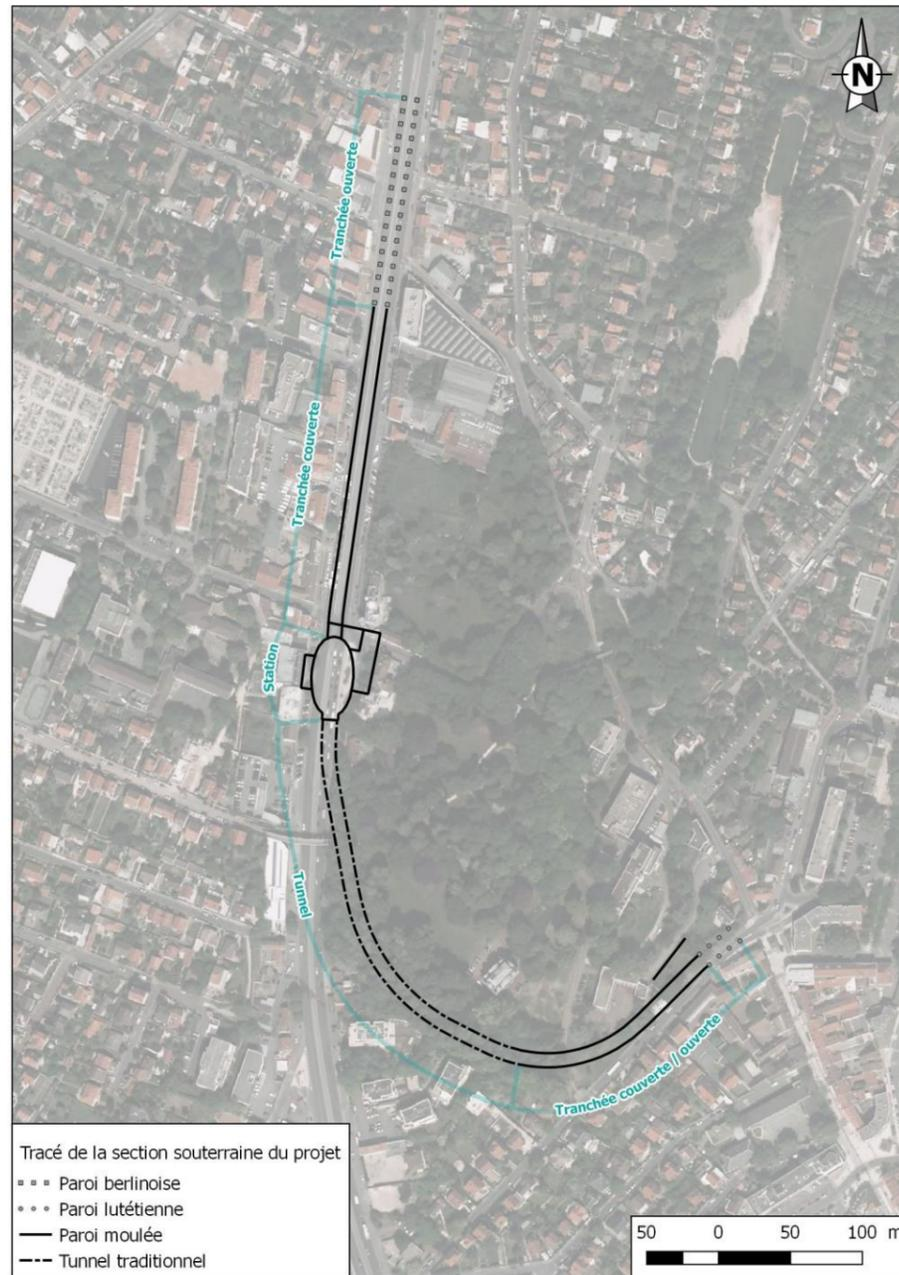
Figure 6 : Localisation des différentes méthodes constructives le long du tracé de la section souterraine du projet (fond : BD ORTHO® IGN)
