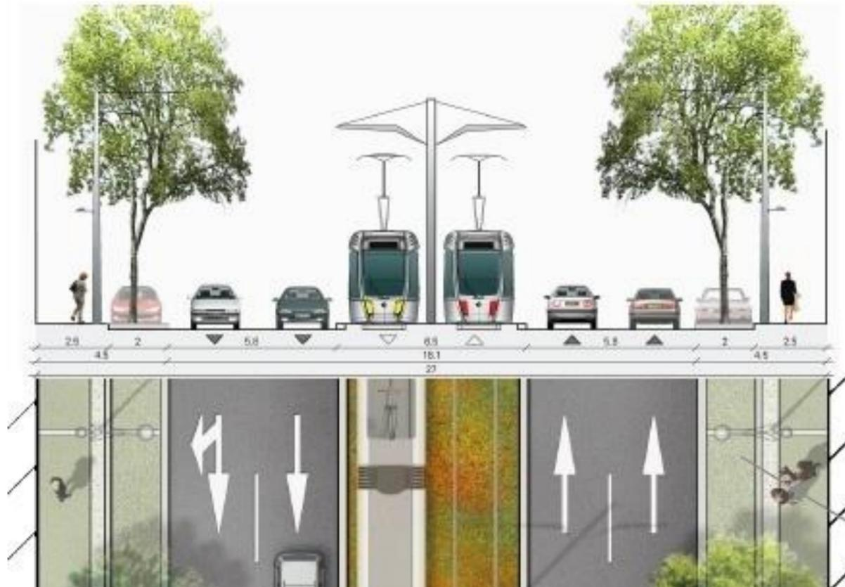
Figure 3 : Profil en travers type du projet le long de la RN7
