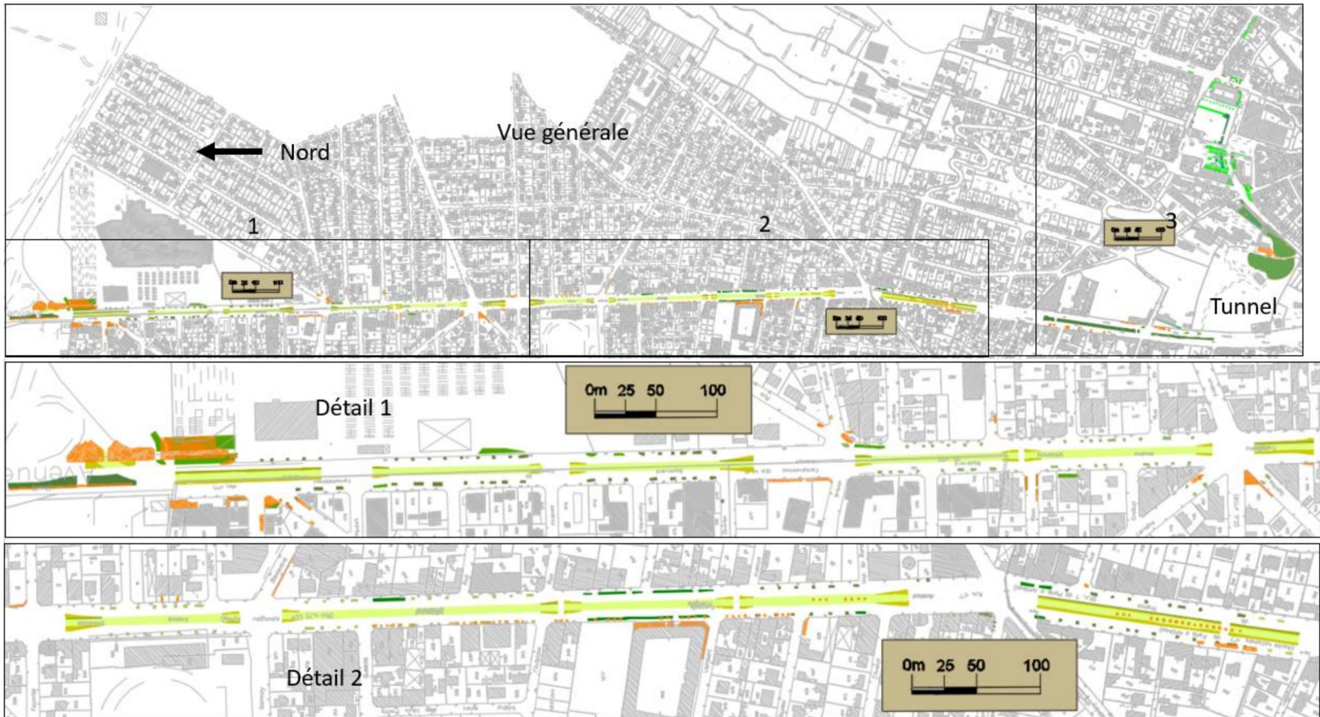
Figure 34 : Vue des espaces enherbés détruits (orange) et construits (verts) infiltrants dans l'emprise du projet (1/2)
