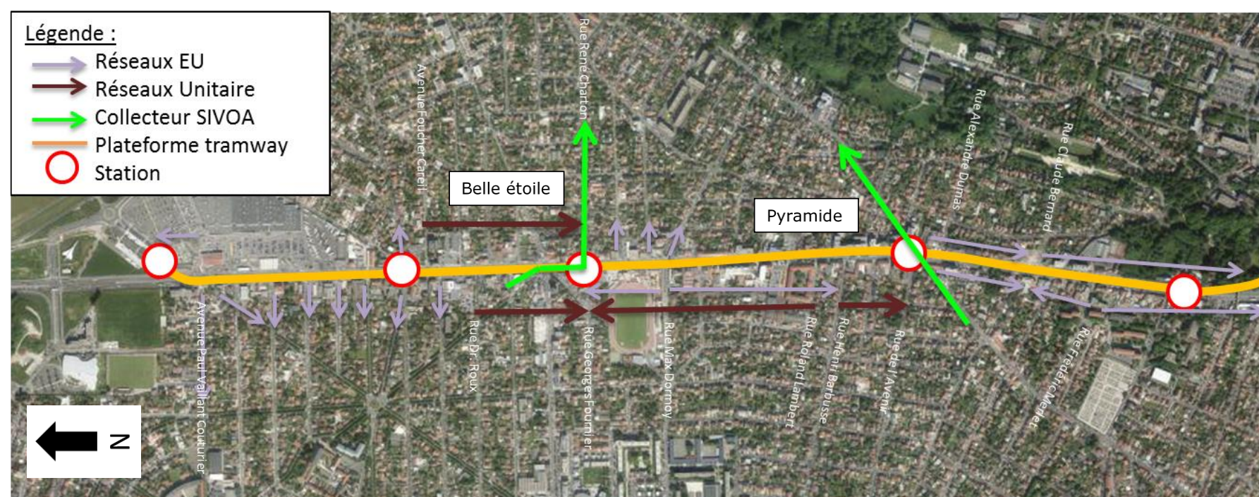
Figure 53 : Synoptique récapitulatif du réseau EU sur la RN7
