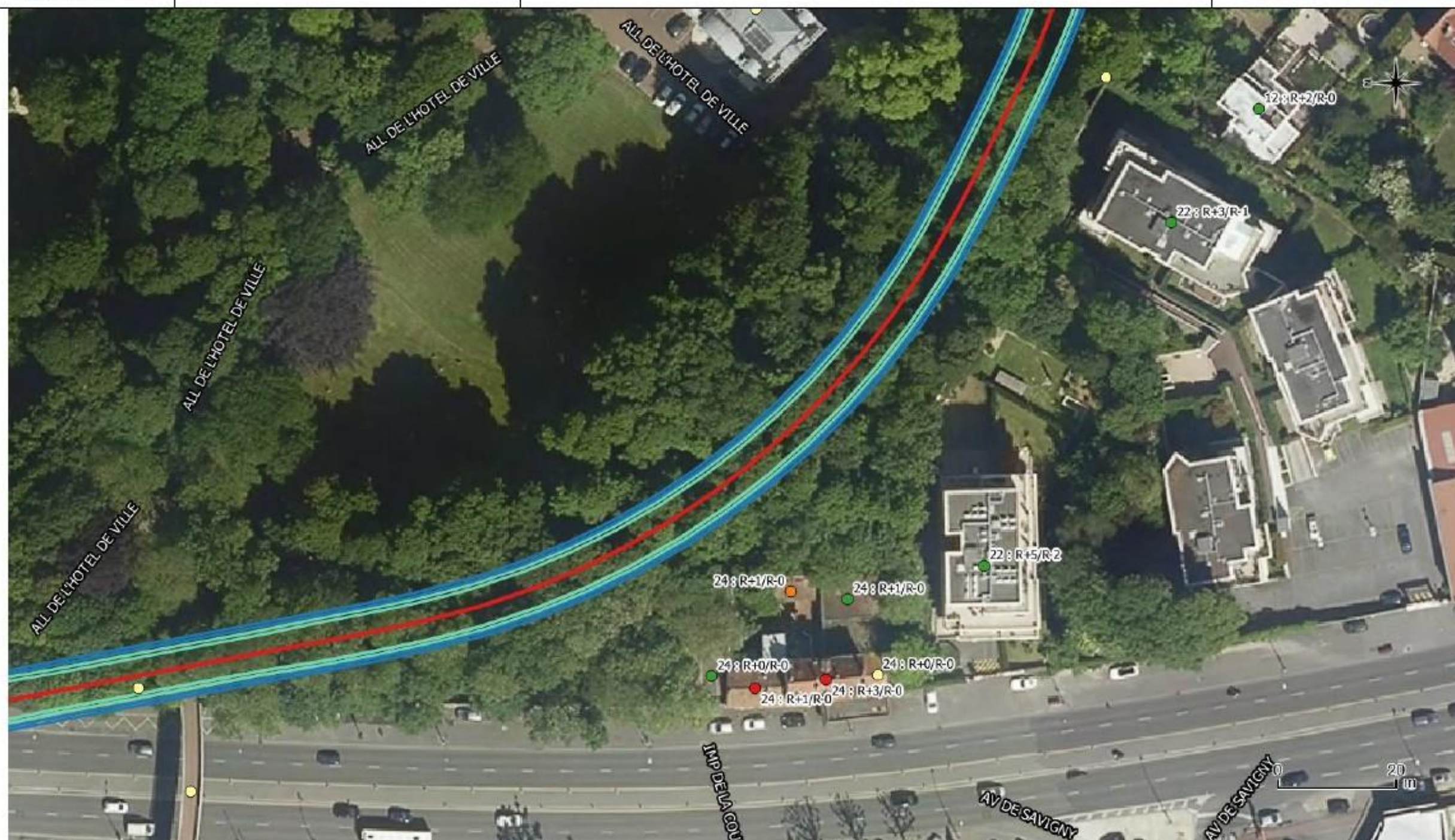
Figure 74 : Sensibilité du parc bâti aux déformations (3/5)
