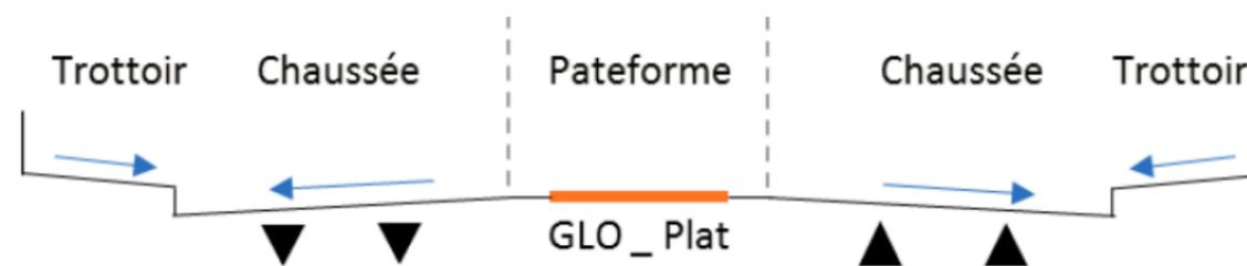
Figure 26 : Profil en travers de la RN7 (source : PRO)
