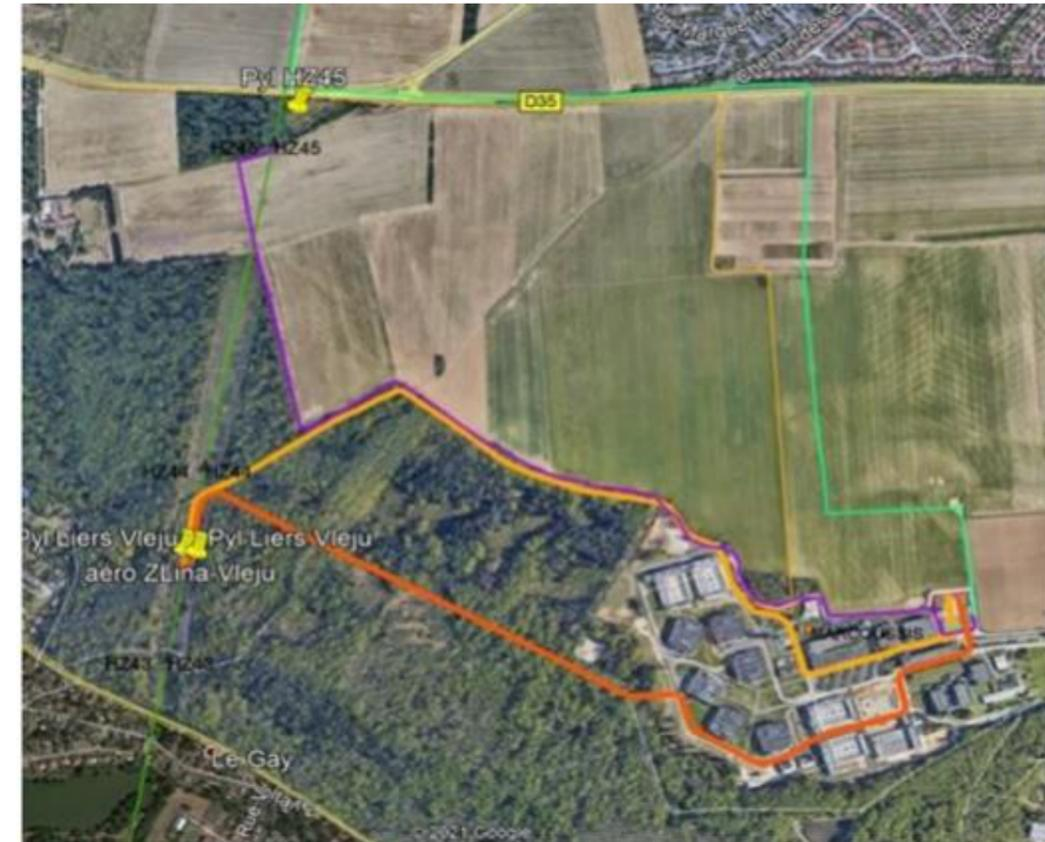
**Figure 5: Travaux d'alimentation souterraine : c'est le tracé en violet qui constitue la solution privilégiée du projet.**
