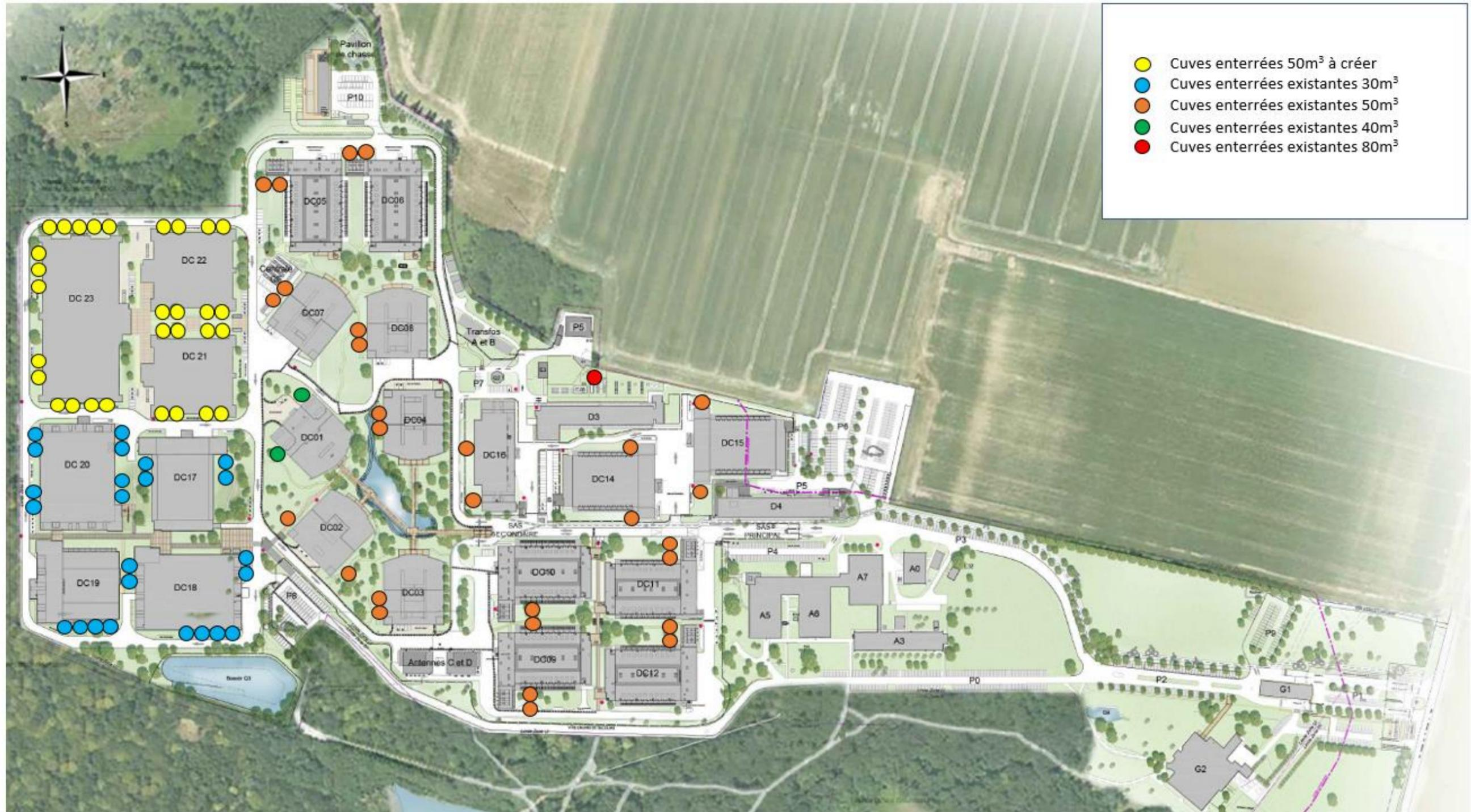
Figure 8 - Plan général de localisation des groupes cuves enterrées du site de Marcoussis
