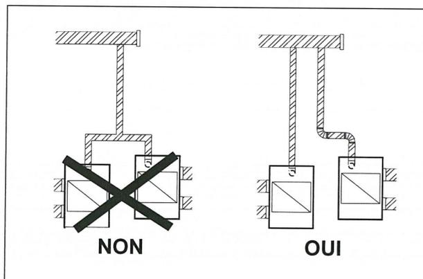
**Figure 21 – Dispositions des gaines de piquages d'air neuf**
