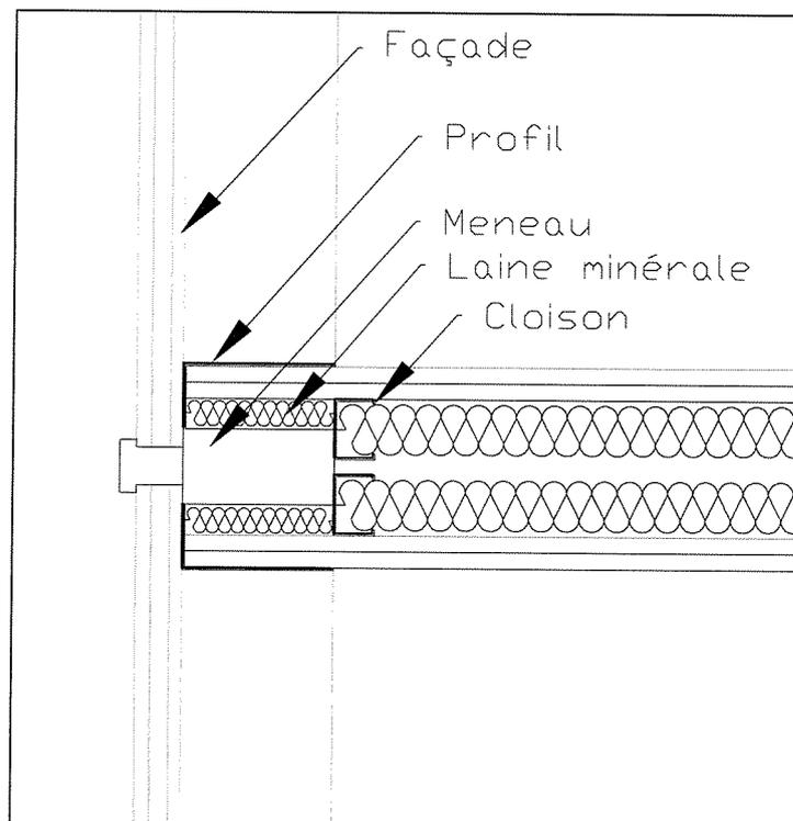
Figure 13 – Principe de jonction cloison BA13-façade
