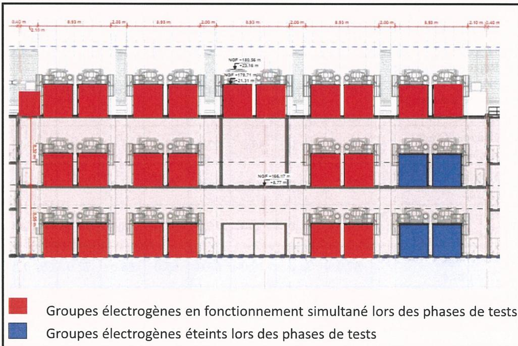
Figure 9 – Localisation des groupes électrogènes
