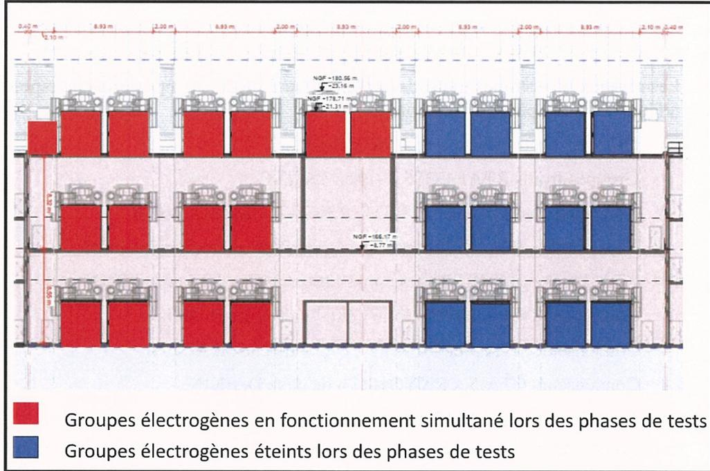
Figure 8 – Localisation des groupes électrogènes
