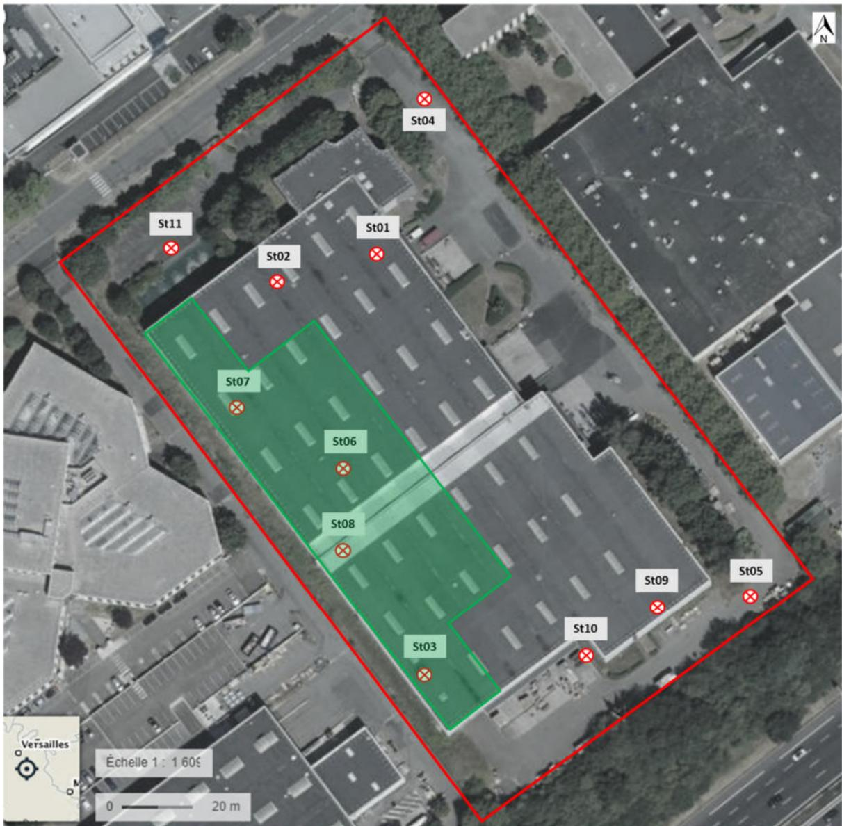
Figure 24 : Localisation des sondages réalisés au droit du site du projet – EODD en 2021
