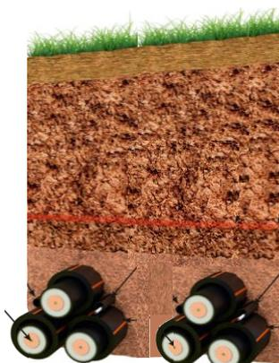
**Sous chemin**, pistes cyclables, en milieu agricole ou en milieu naturel, les liaisons sont posées en « pleine terre ». Cela permet de limiter les engins de chantiers nécessaires (pas de bétonneuse), de limiter l'impact sur le milieu naturel, mais nécessite l'ouverture d'une fouille sur plusieurs centaines de mètres.
