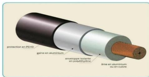
Exemple de structure d'un câble conducteur isolé à haute-tension
