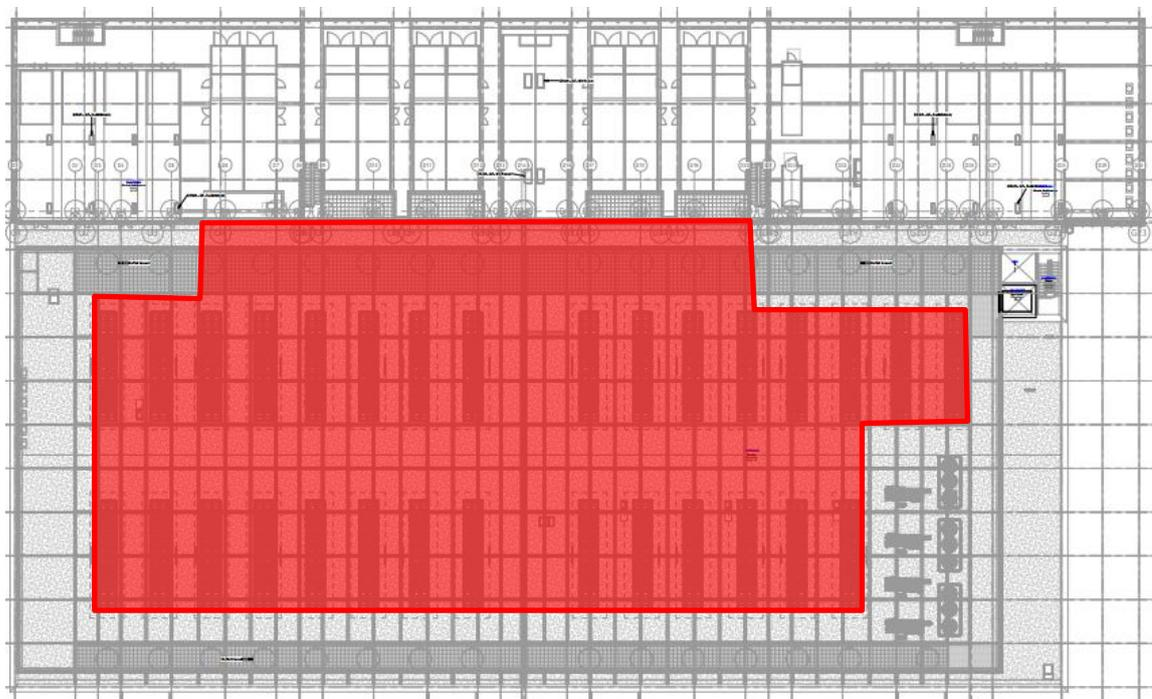
Figure 15 – Localisation de la couverture métallique des groupes froids
