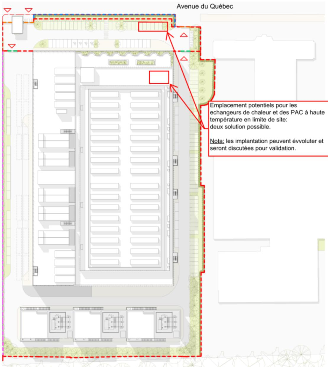
Figure 8 Zone potentielle d'implantation sur Villebon PAR2
