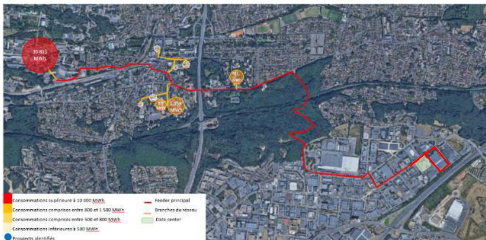
Figure 6 Tracé du réseau de chaleur
