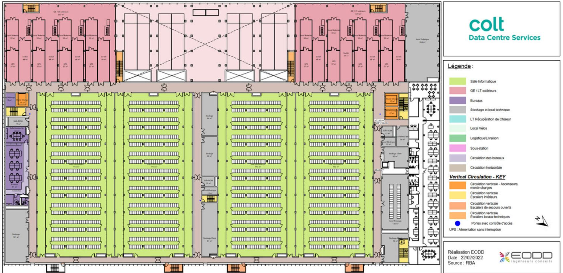
Figure 14 : Répartition des locaux et installations – Niveau 2
