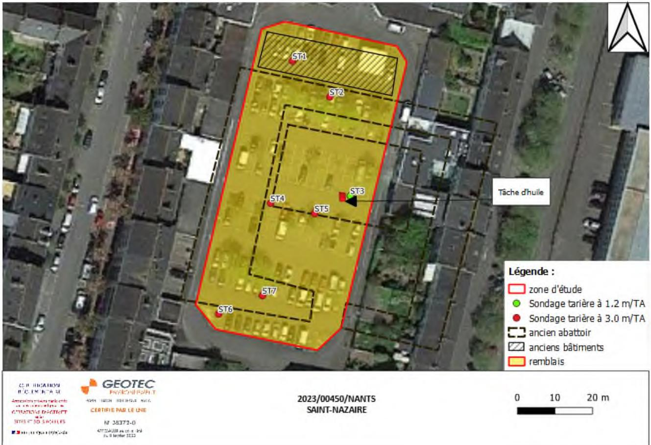
Figure 15 : Plan d'implantation des sondages réalisés
