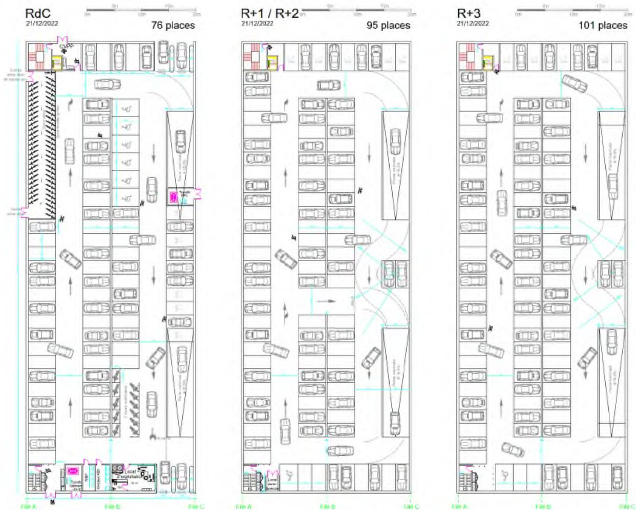
Figure 3 : Plan de masse des différents niveaux du parking à étages (SONADEV)
