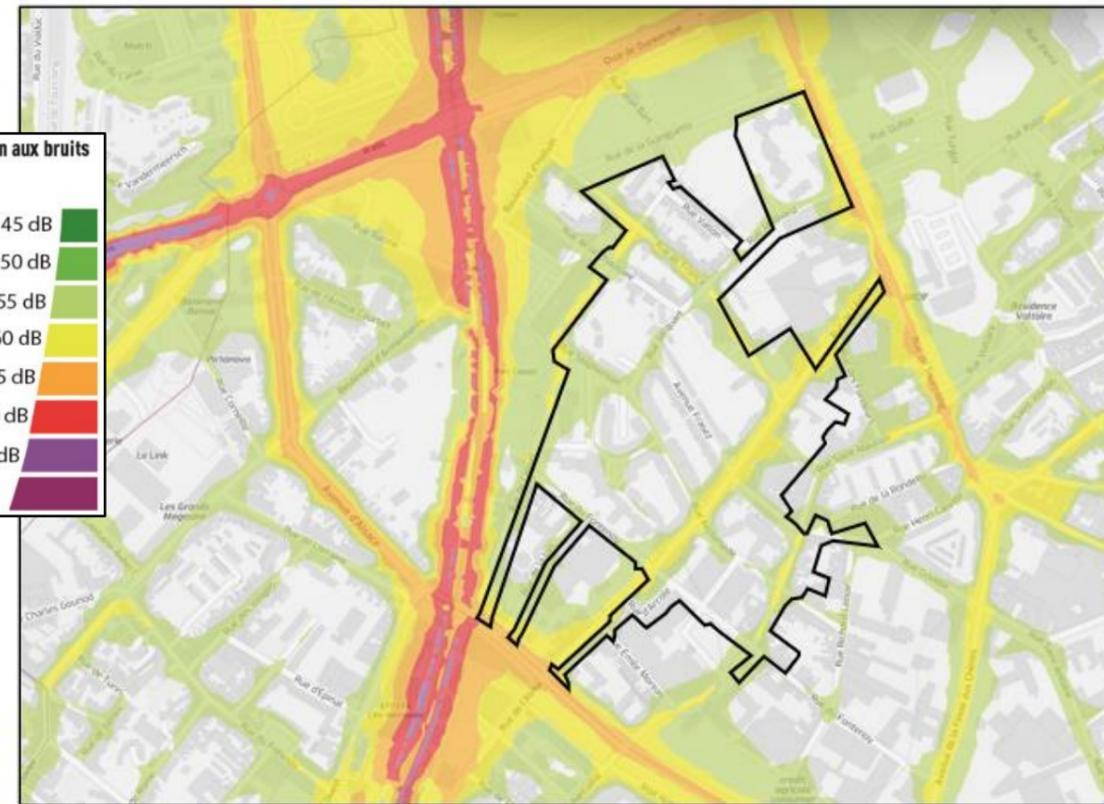
Figure 142 - Carte de type « C » - Dépassement de seuil au niveau d'exposition Lden pour le bruit routier
