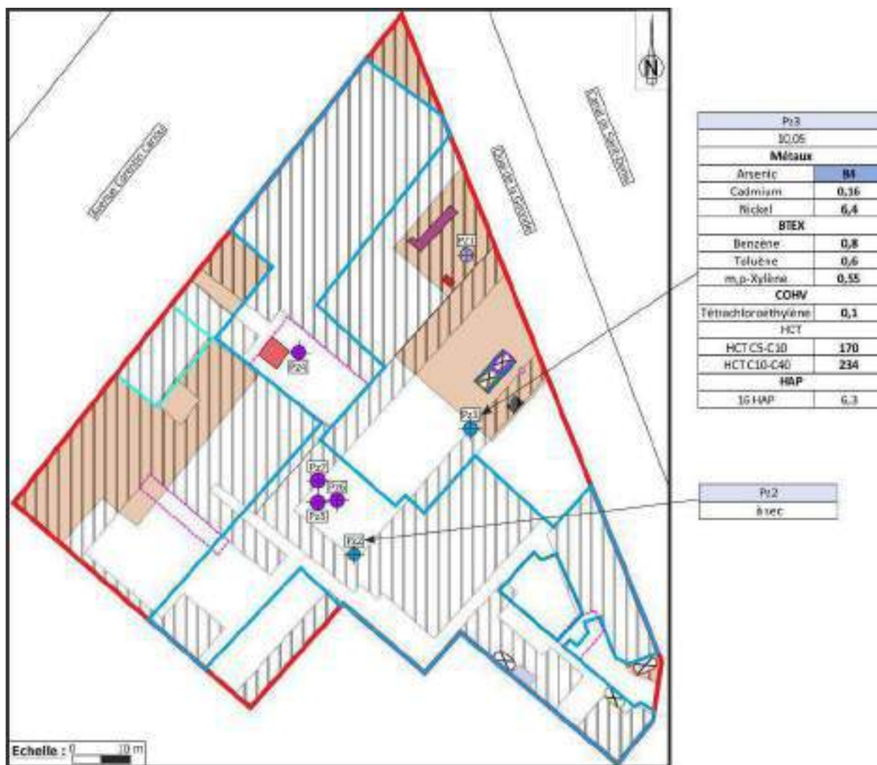
Figure 41 : Cartographie des résultats d'analyses des eaux souterraines pour le risque sanitaire Source fond de carte : site Internet cadastre.gouv.fr
