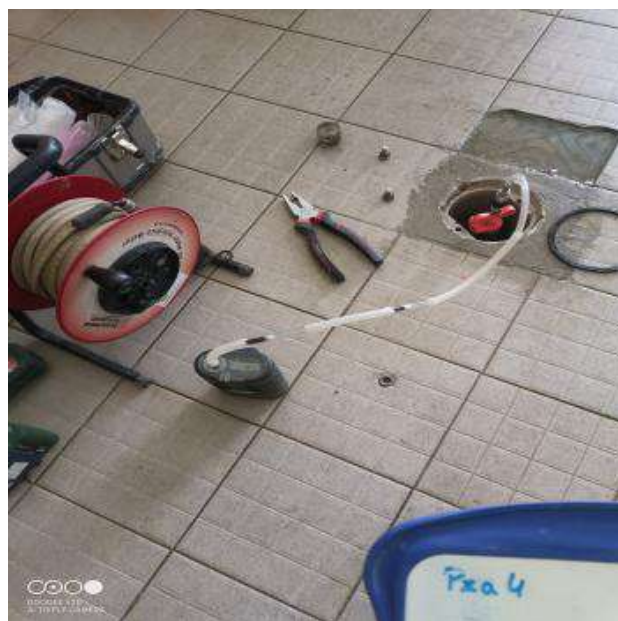
Vue générale du dispositif de prélèvement (point de prélèvement jusqu'à la pompe)
