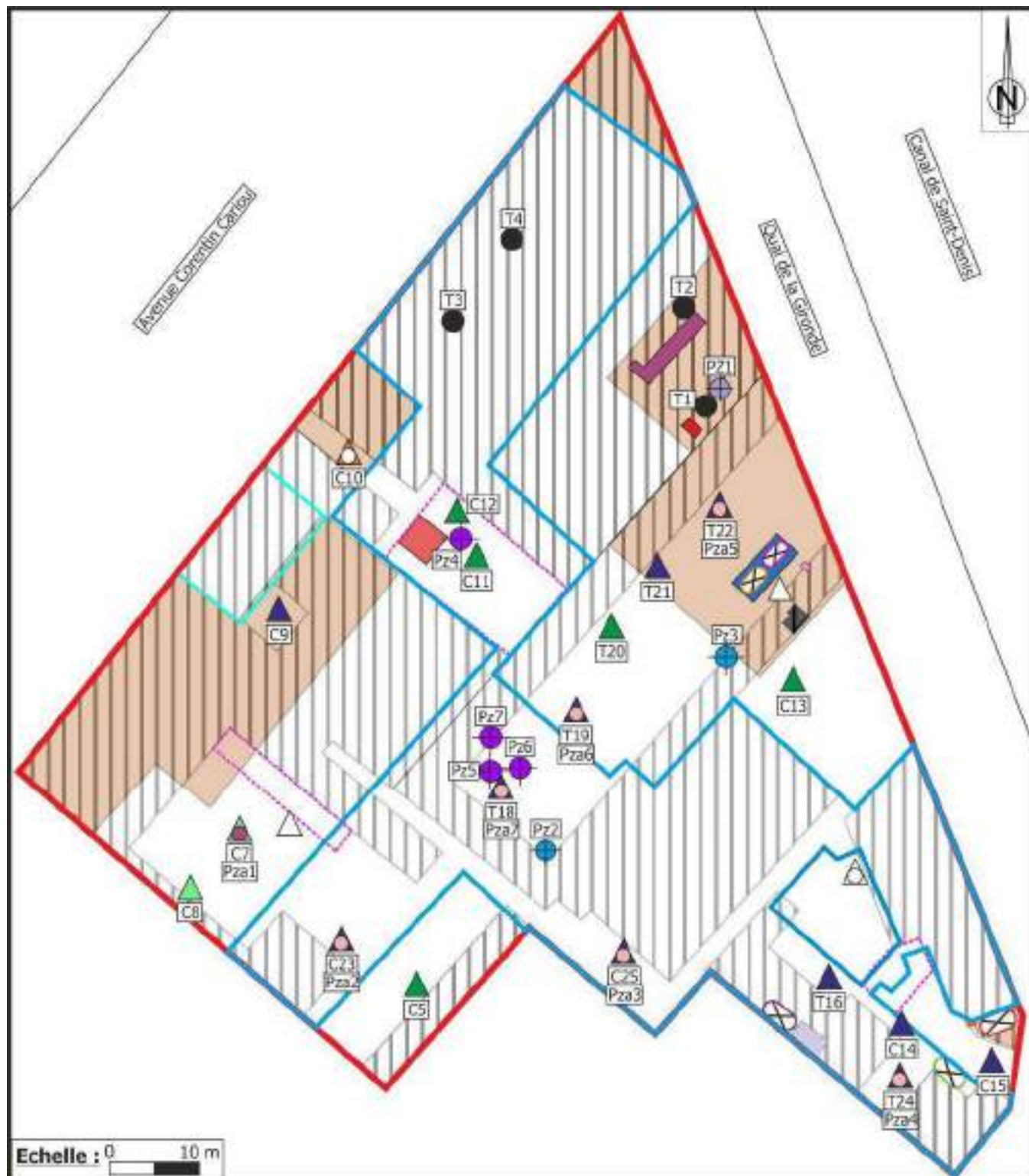
Figure 33 : Plan d'implantation des sondages, piézomètres et piézairs Source fond de carte : www.cadastre.gouv.fr
