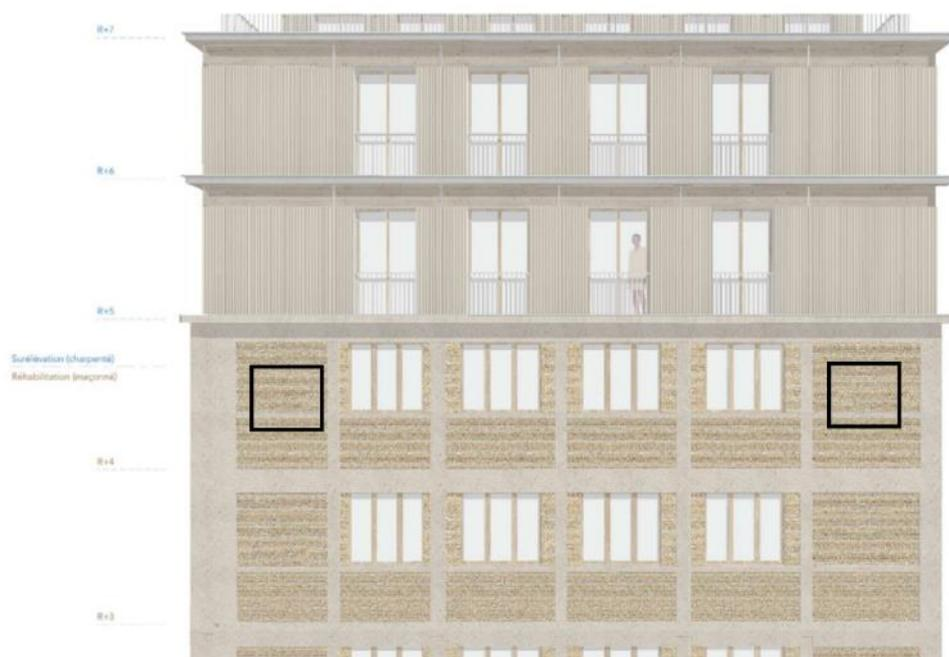
Figure 27 : Propositions d'implantation de gîtes à chiroptères sur la façade rénovée de l'imprimerie
