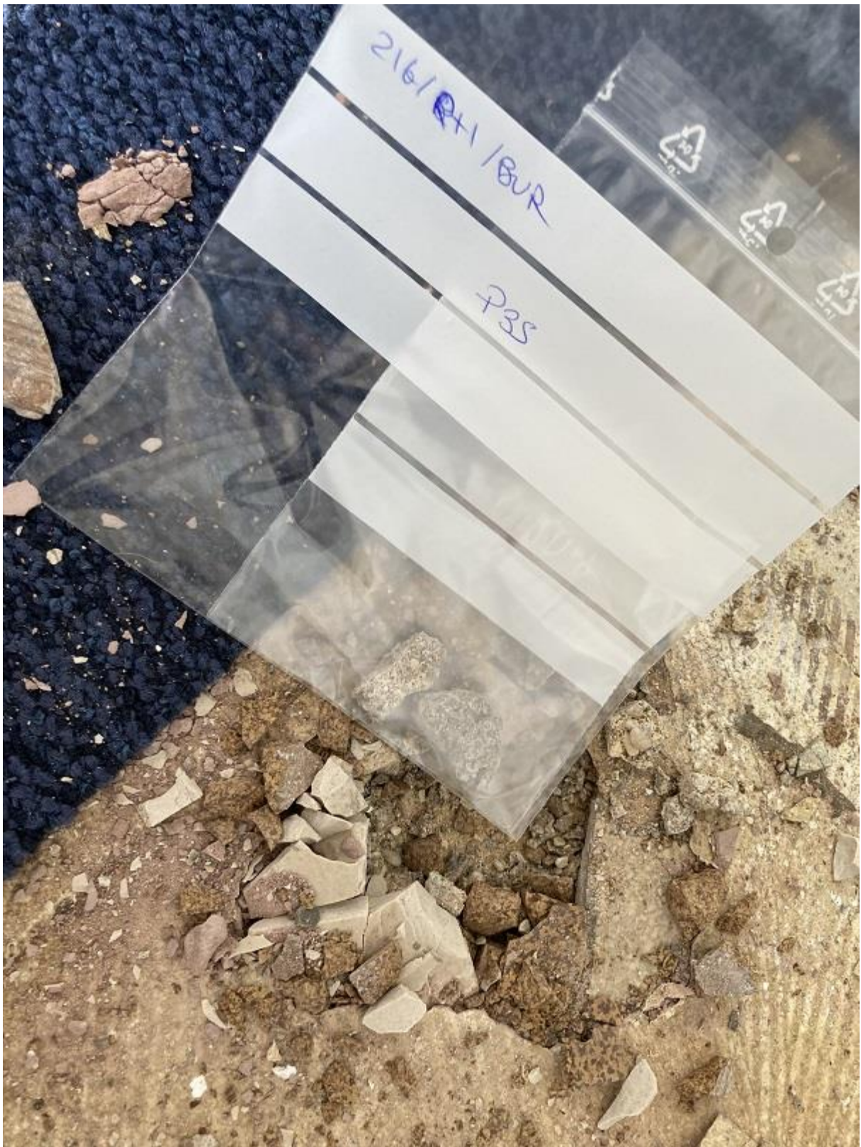
Prélèvement n°35 : Pas de fibres d'amiante détectées après analyse en laboratoire.
