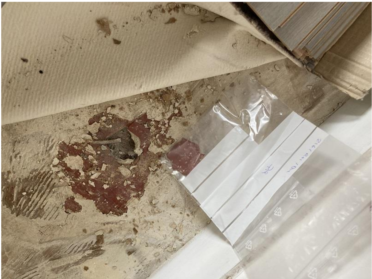
Prélèvement n°19 : Le linoleum rouge (situé sous la moquette) contient de l'amiante après analyse en laboratoire.
