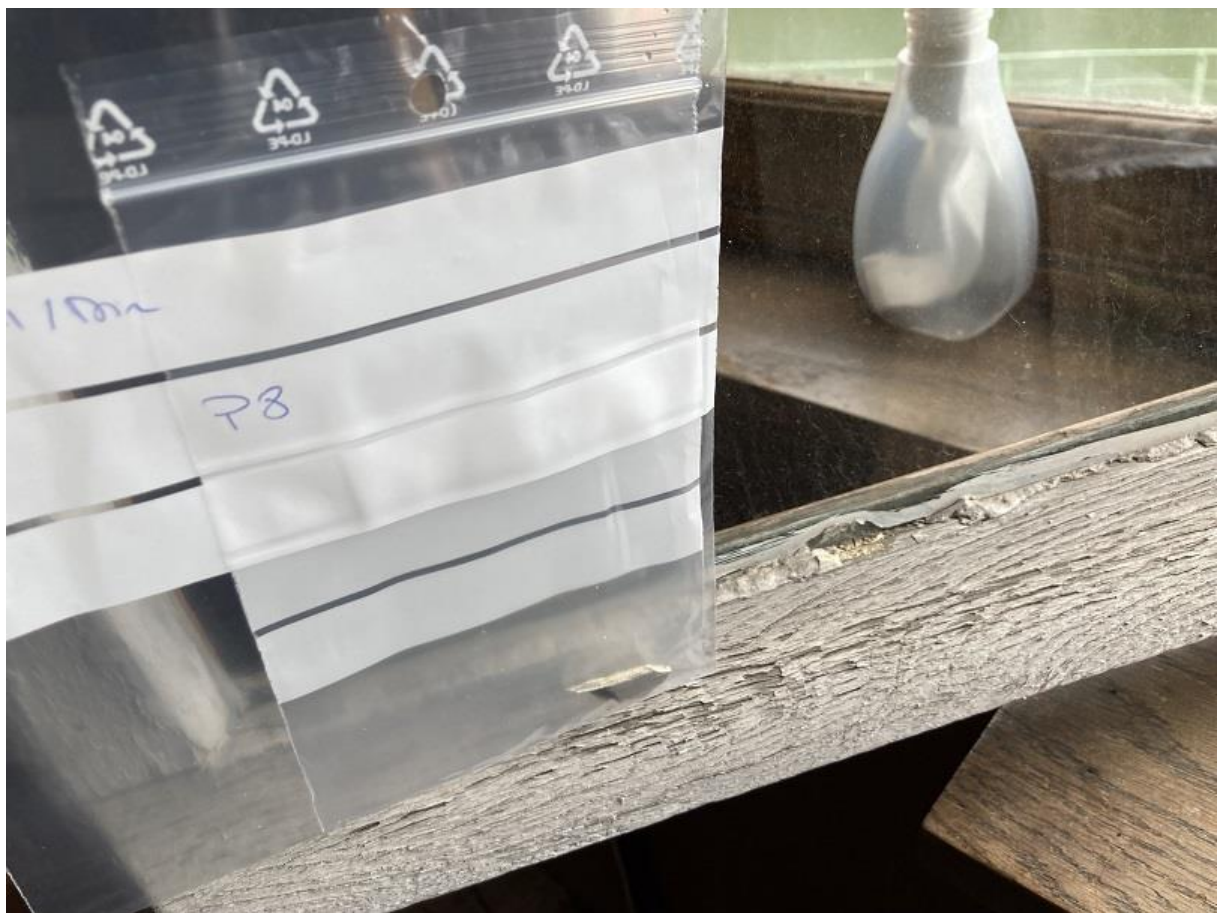
Prélèvement n°8 : Pas de fibres d'amiante détectées après analyse en laboratoire.
