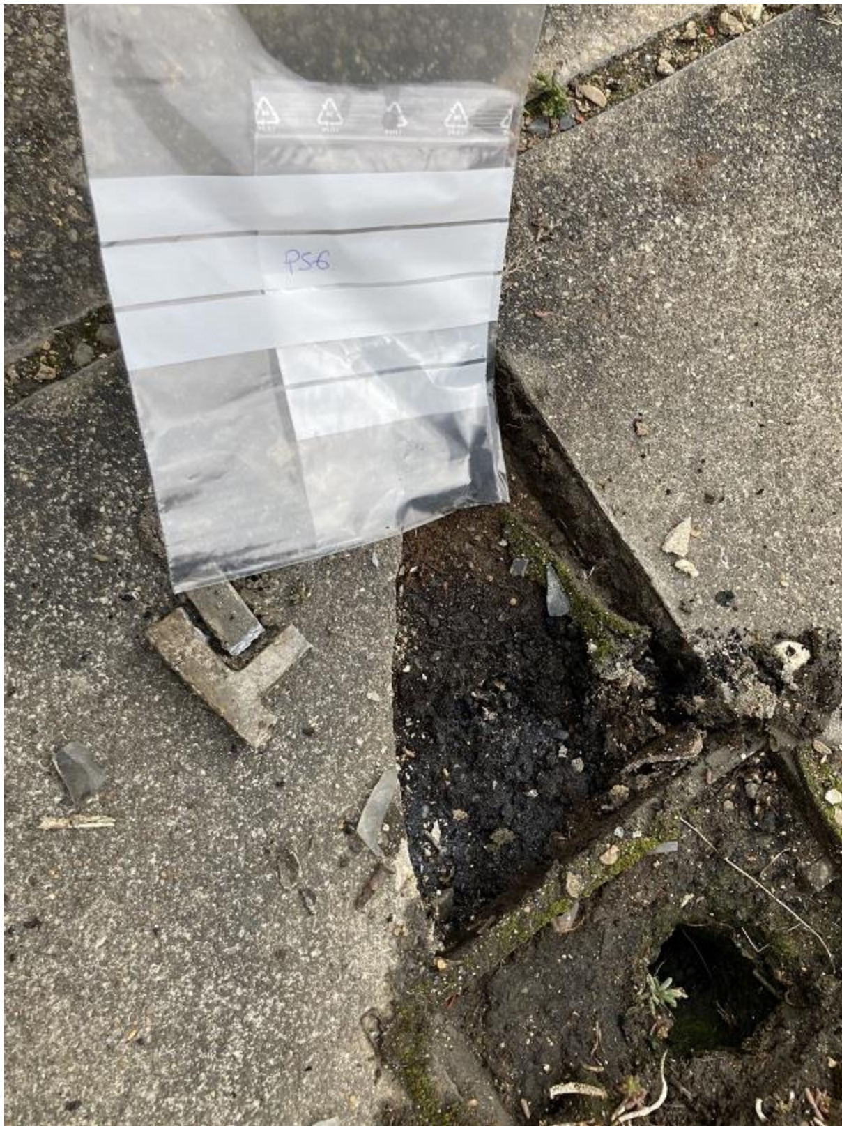
Prélèvement n°56 : Pas de fibres d'amiante détectées après analyse en laboratoire.
