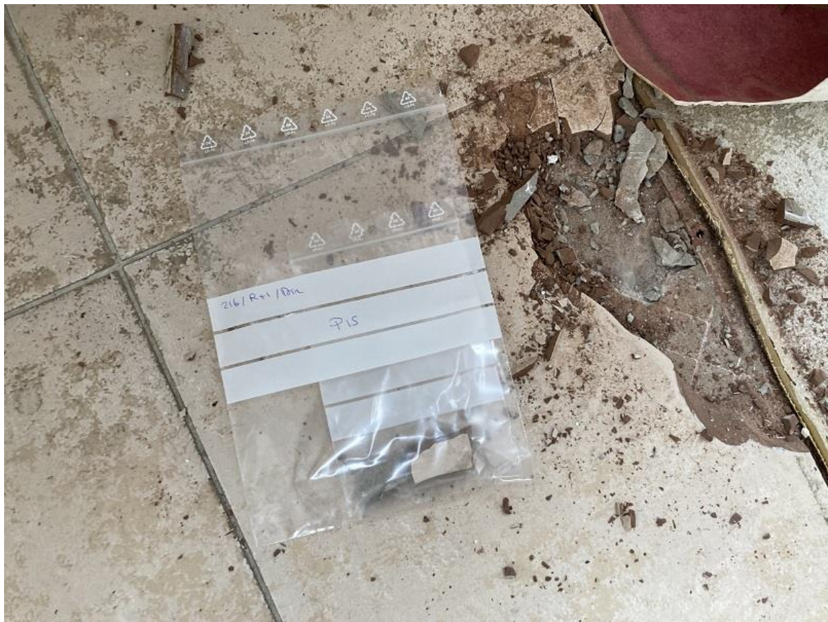
Prélèvement n°15 : Pas de fibres d'amiante détectées après analyse en laboratoire.
