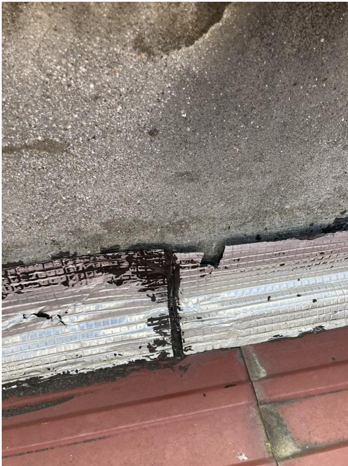
Prélèvement n°59 : Pas de fibres d'amiante détectées après analyse en laboratoire.
