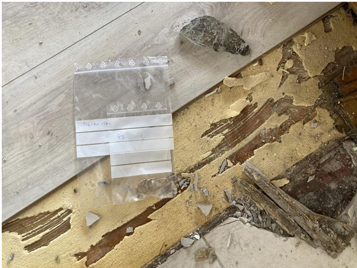
Prélèvement n°5 : Pas de fibres d'amiante détectées après analyse en laboratoire.
