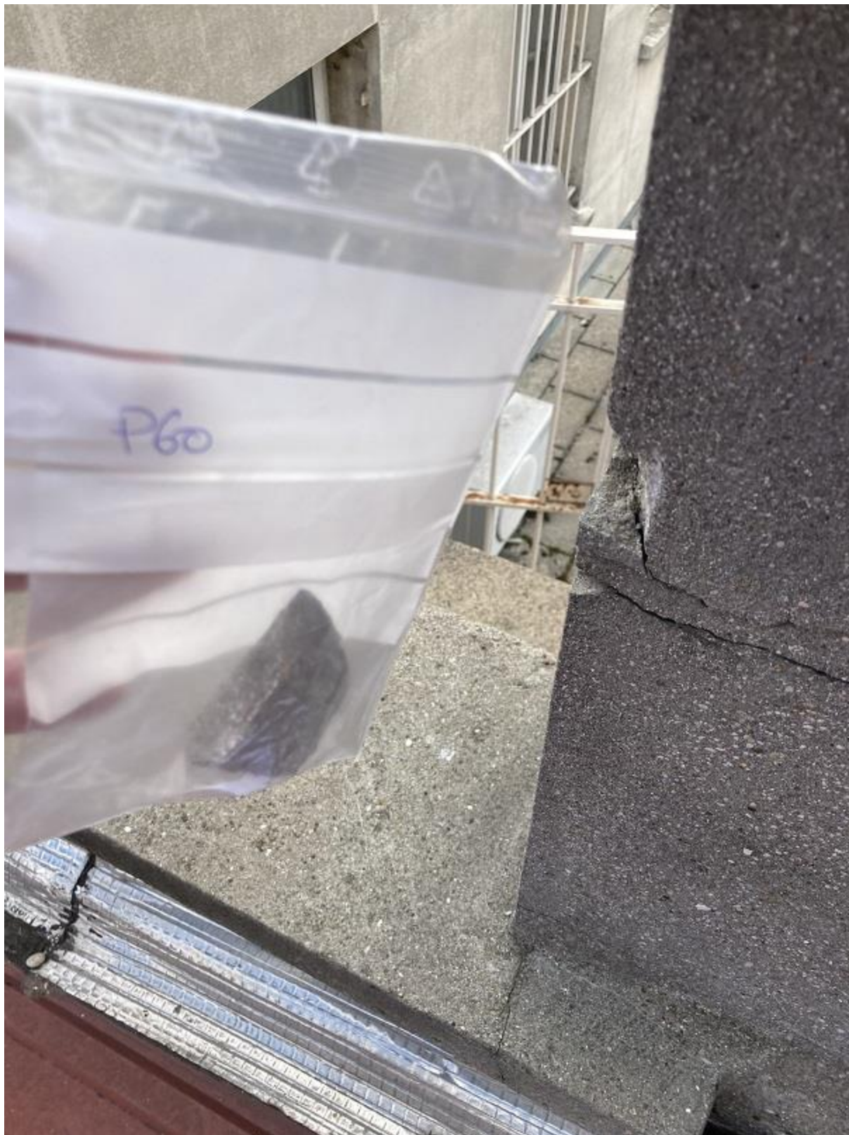
Prélèvement n°60 : Pas de fibres d'amiante détectées après analyse en laboratoire.
