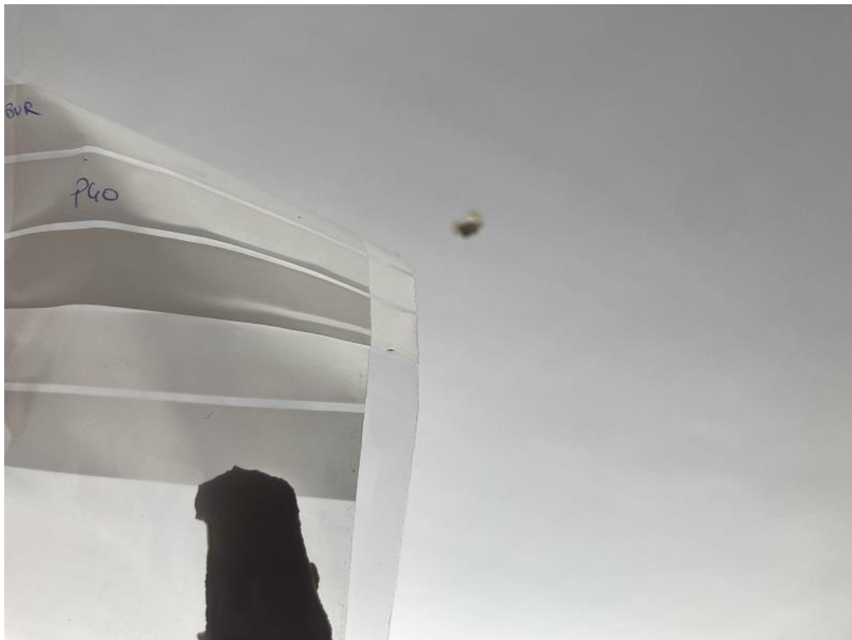
Prélèvement n°40 : Pas de fibres d'amiante détectées après analyse en laboratoire.
