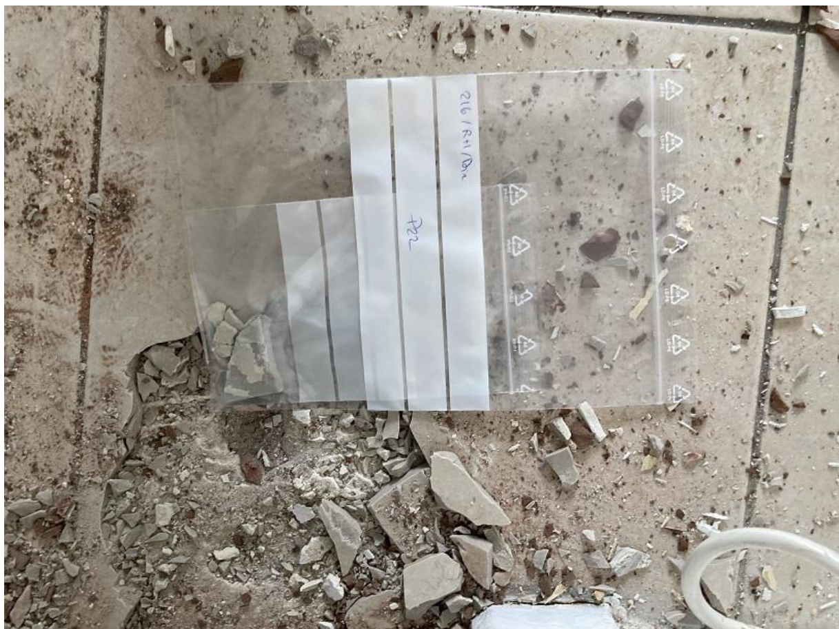
Prélèvement n°22 : Pas de fibres d'amiante détectées après analyse en laboratoire.
