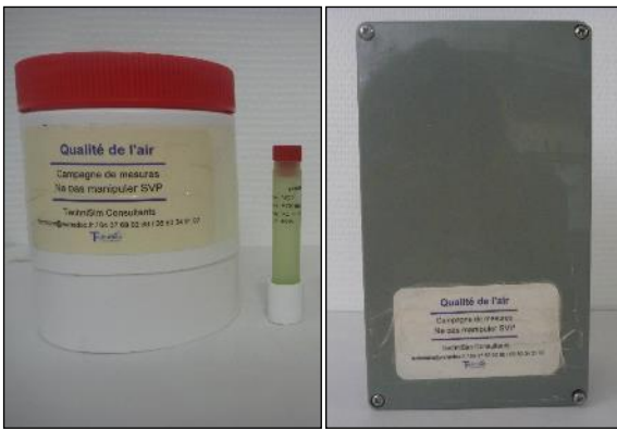
Figure 37 : Réceptacle, tube passif pour le NO 2 et micro-capteur laser pour les particules
