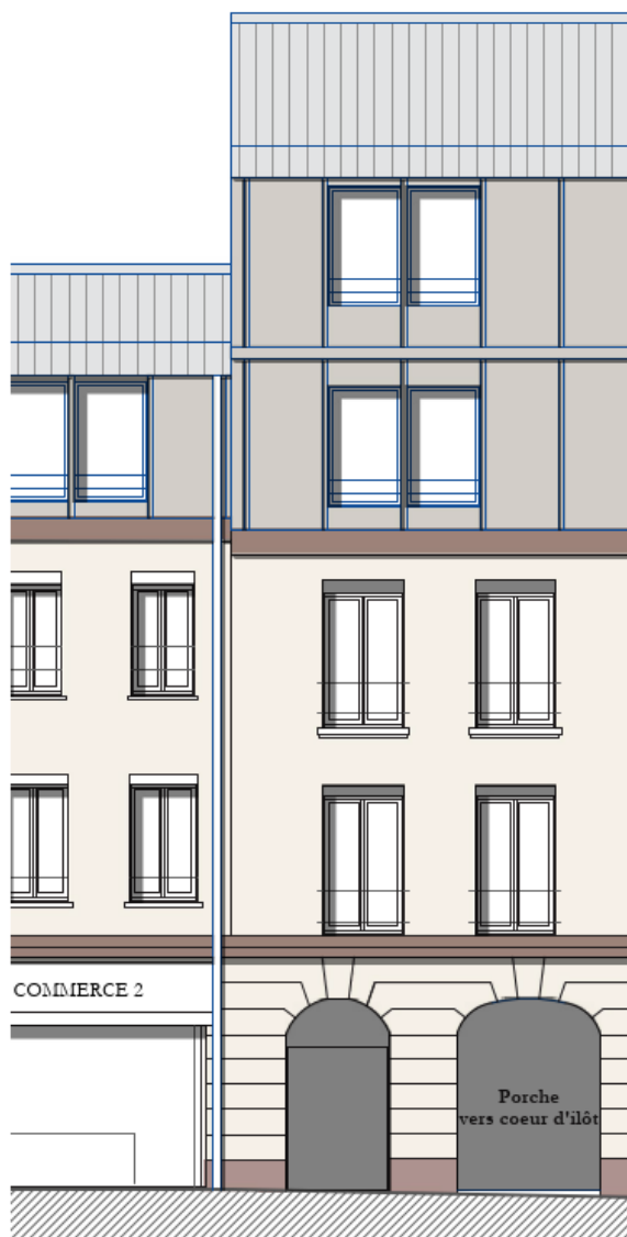
Bâtiment H (Réhabilité + surélévation) - Pierre Antoine Gatier Architecte
