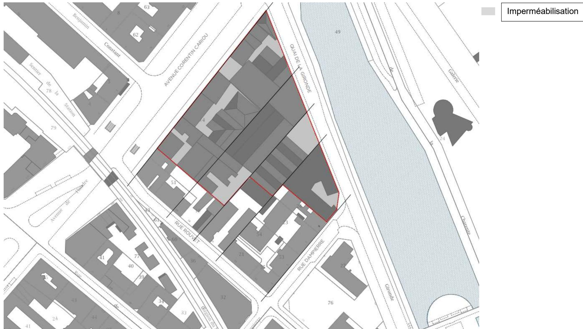
Figure 4 : imperméabilisation du site à l'état existant
