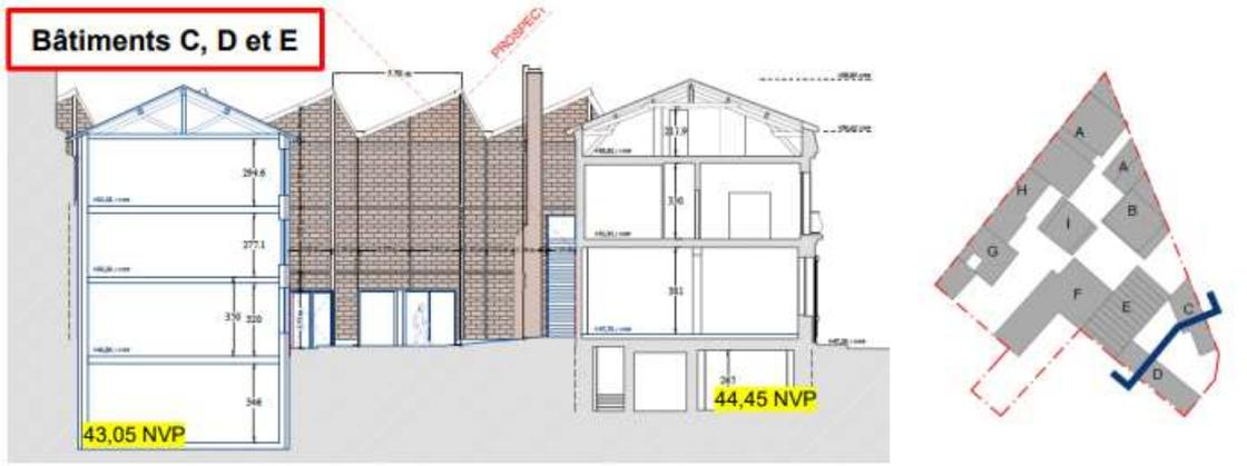
Figure 8 – Extrait des plans de coupes des bâtiments C et D, datés du 17/11/2023
