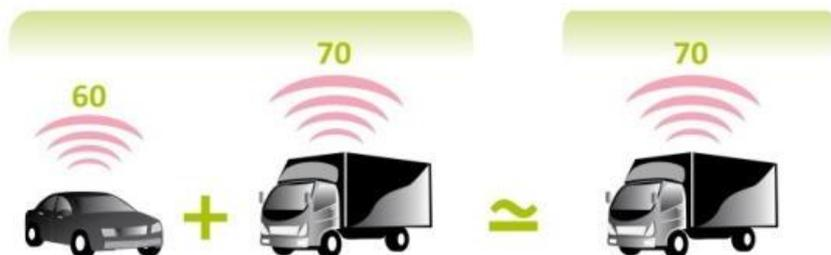
Figure 4 : Deux sources d'intensité différente (source : EGIS/ACOUSTB)
