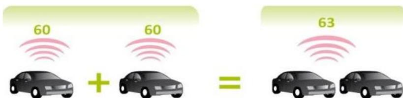
Figure 3 : Doublement de l'intensité sonore (source : EGIS/ACOUSTB)
