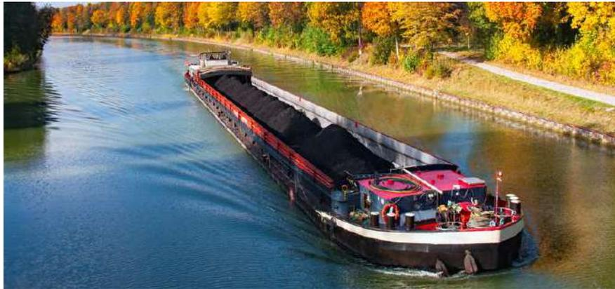
Figure 2 - Exemple d'automoteur
