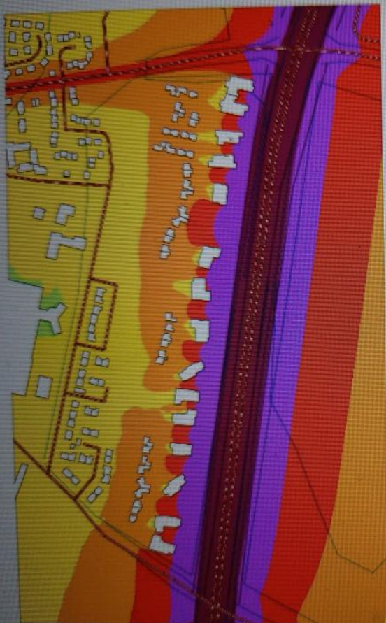
Illustration 6: Illustration 6: simulation présentée par le BET Socotec p.81 de l'annexe 6. Il montre que pour les logements collectifs situés au bord de l'autoroute A 14 le niveau de bruit pour les logements en R+3 sera très élevé et supérieur à 70 dB(A) en façade
