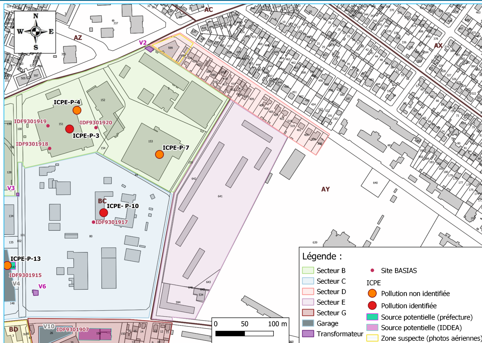
Figure 26 : Plan de localisation des activités et installations potentiellement polluantes des secteurs D et E (source : cadastre / QGIS)
