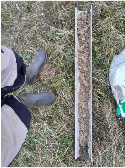
Remblais de sables sur 1m20
