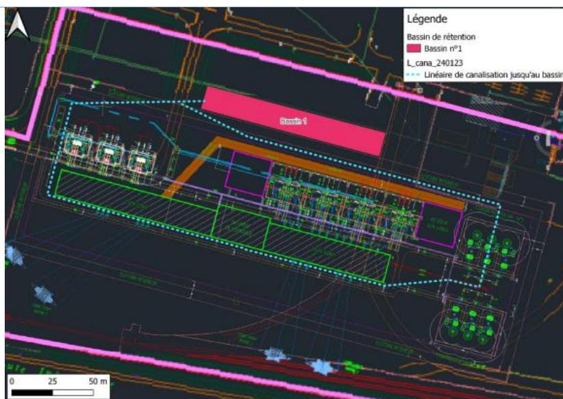
Afin de dimensionner le diamètre de ces canalisations, la formule de Manning-Strickler a été considérée en prenant en compte un diamètre unique pour l'ensemble des eaux récoltées sur les zones imperméables.
