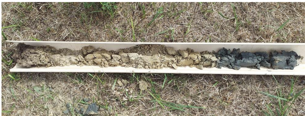
Figure 29 : Sondage n°3 – Sol caractéristique de zone humide - Source : Biotope, 2022
