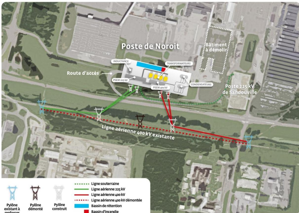
Figure 1 : Schéma d'implantation du poste de Noroit
