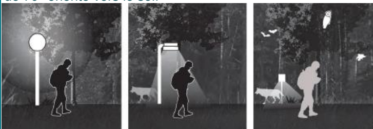
Plus la lumière est focalisée sur sa cible, moins elle affecte les espèces : le cas présenté à gauche est donc à proscrire ; Longcore, 2016
