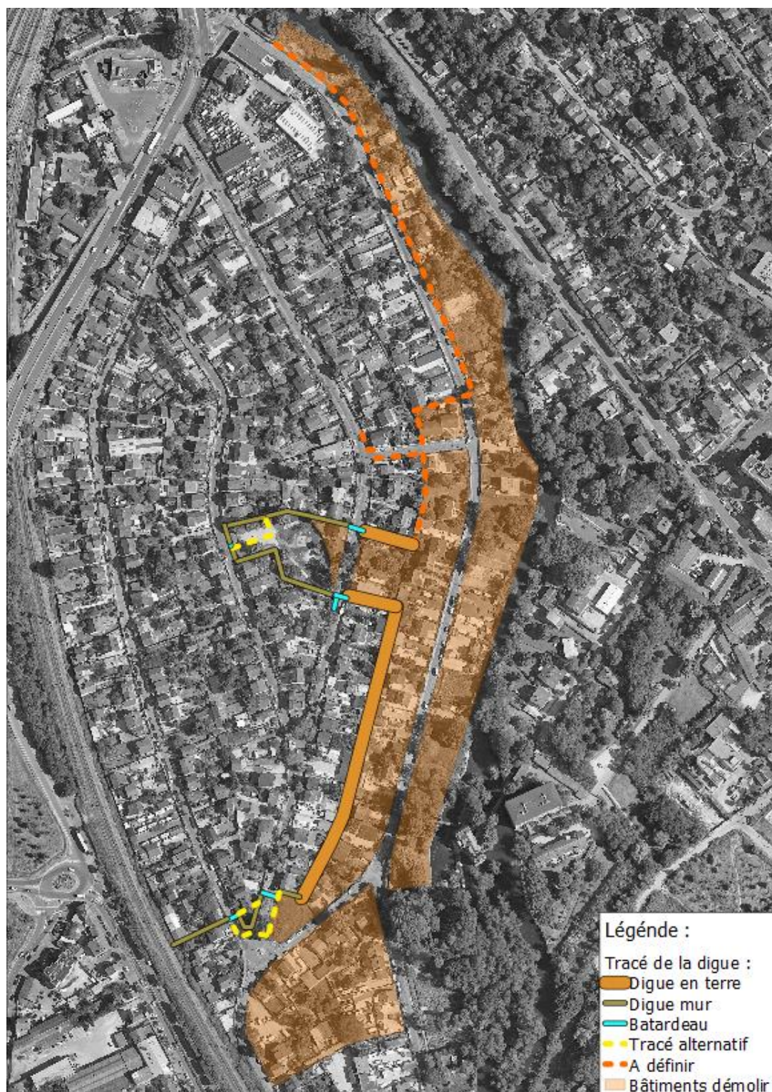
Figure 26 : Possibles tracés de la digue
