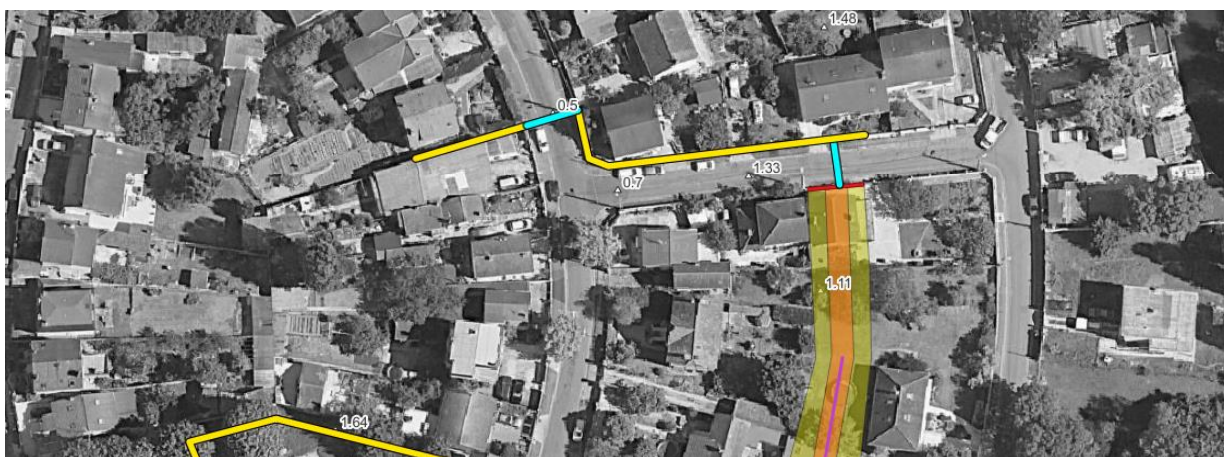
Figure 47 : Emprise prévisionnelle de l'ouvrage de protection en remblai au Nord, en cas d'absence de protection le long du chemin des pêcheurs
