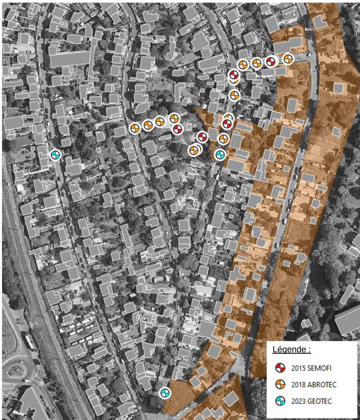
Figure 13 : Implantation des sondages géotechniques. Source : rapports géotechniques de campagnes 2015, 2018 et 2023
