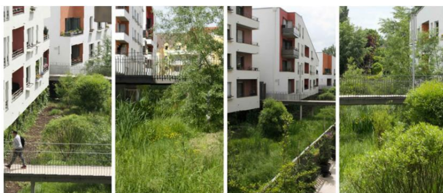
Aménagement en zone inondable, avec noue centrale pour l'écoulement des eaux (Source : CEREMA)
