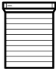
Volet roulant avec caissons apparents
