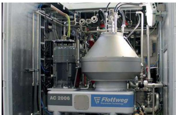
Dans les cas où une pureté optimale des hydrocarbures est nécessaire, la purification en aval par le biais des Séparateur Flottweg AC s'impose. En outre, le système de débouillage Soft Shot® offre beaucoup d'avantages.
