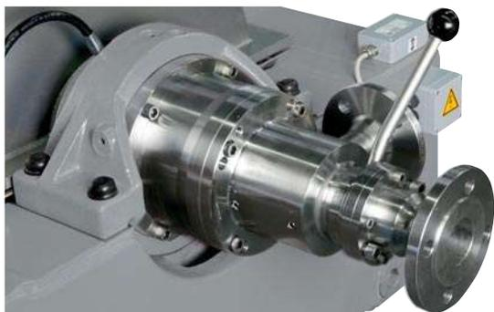
Lever de la turbine centripète réglable en marche sur le Tricanter® Flottweg
