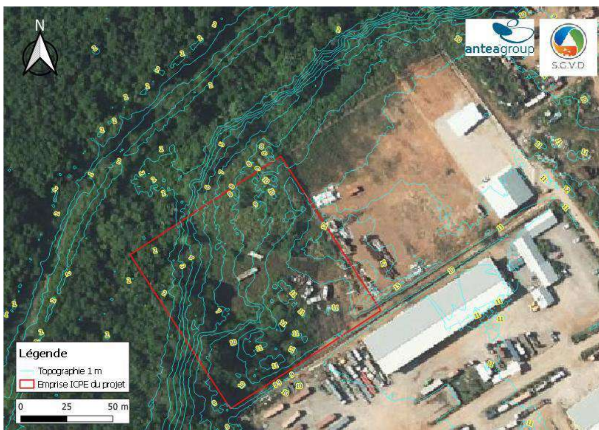
Figure 8 : Levé topographique de la zone d'étude (source ANTEA)
