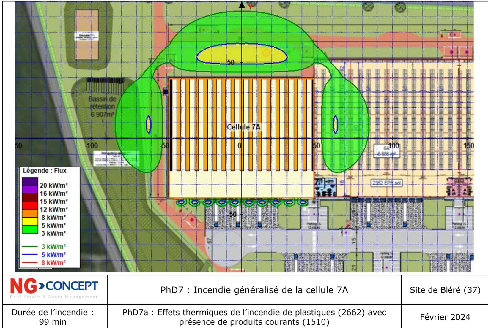
Figure 28 : Représentation graphique des effets thermiques de l'incendie généralisé de la cellule 7A dans le cas de stockage de plastiques (2662) avec présence de produits courants (1510) (PhD7a)
