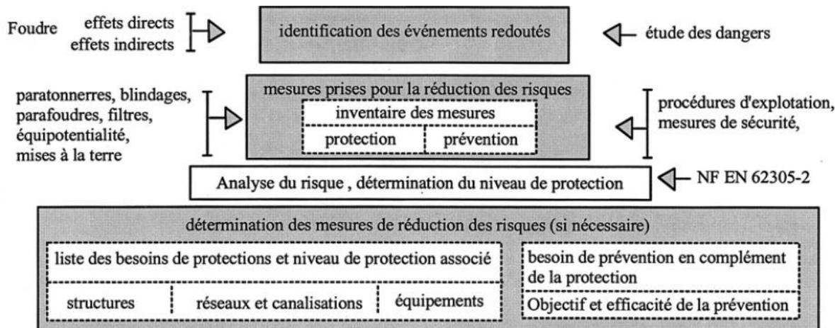
La norme NF EN 62305-2 fixe la limite supérieure du risque tolérable  $10 E^{-5}$  pour le risque de perte de vie humaine. Lorsque le risque calculé est supérieur au risque tolérable, des mesures de protection et de prévention sont intégrés aux calculs jusqu'à ce que le risque soit rendu acceptable.
