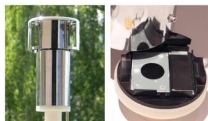
Figure 7 : Capteur SIGMA-2 pour matière particulaire et substrat adhésif pour échantillonnage
