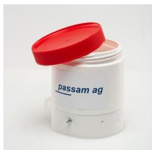
Figure 6 : échantillonneur passif de longue durée de la marque Passam AG
