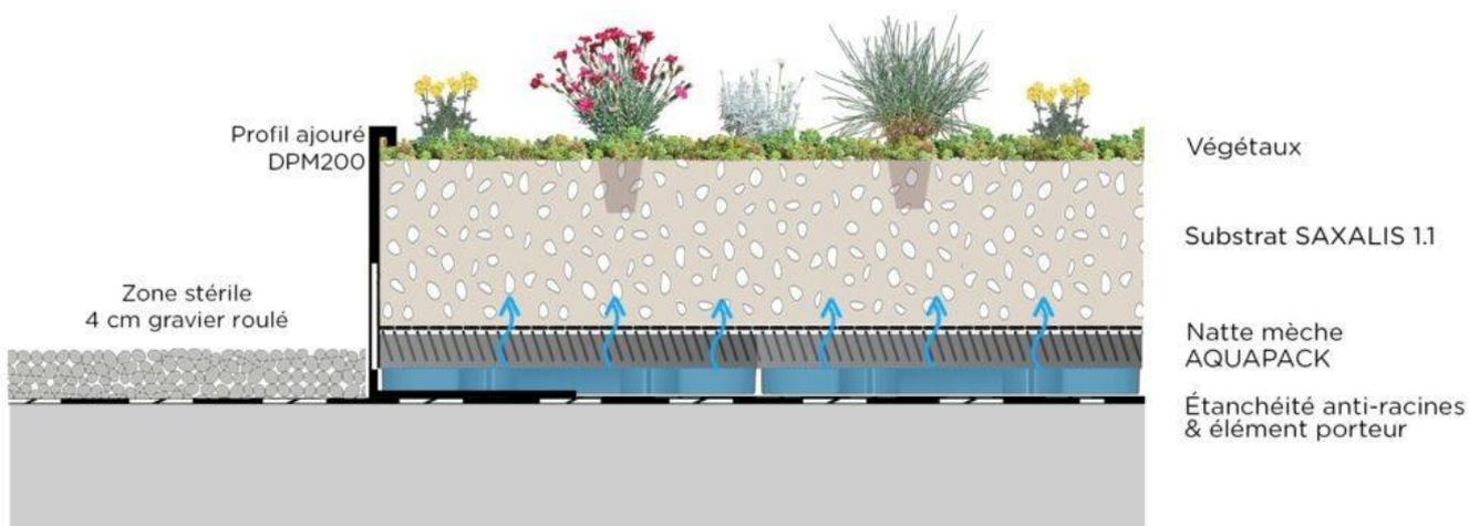
Le système de drainage sera complété par des nattes mèches permettant de faire remonter l'eau par capillarité dans la terre végétale.
