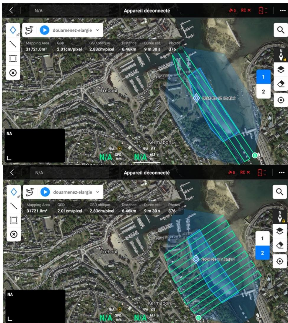
Figure 1 : Zone à lever par drone (source Balao)
