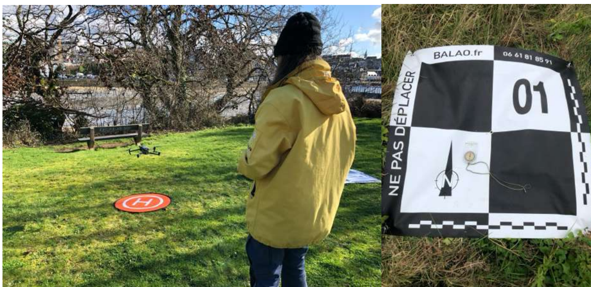
Figure 2 : Décollage du drone et cible géoréférencée (source Balao)
