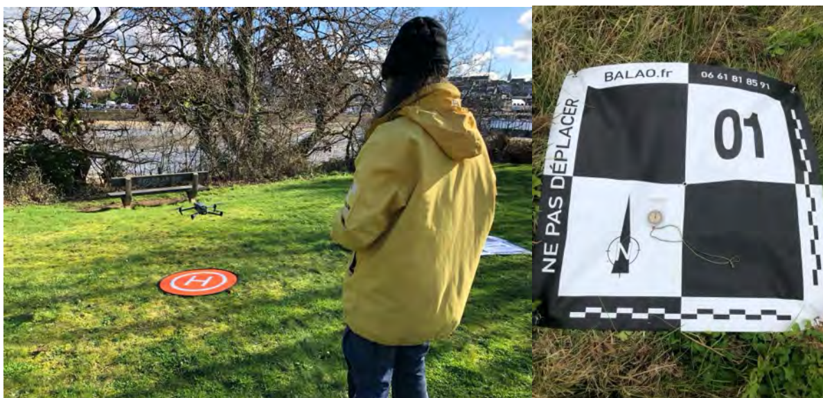
Figure 2 : Décollage du drone et cible géoréférencée (source Balao)
