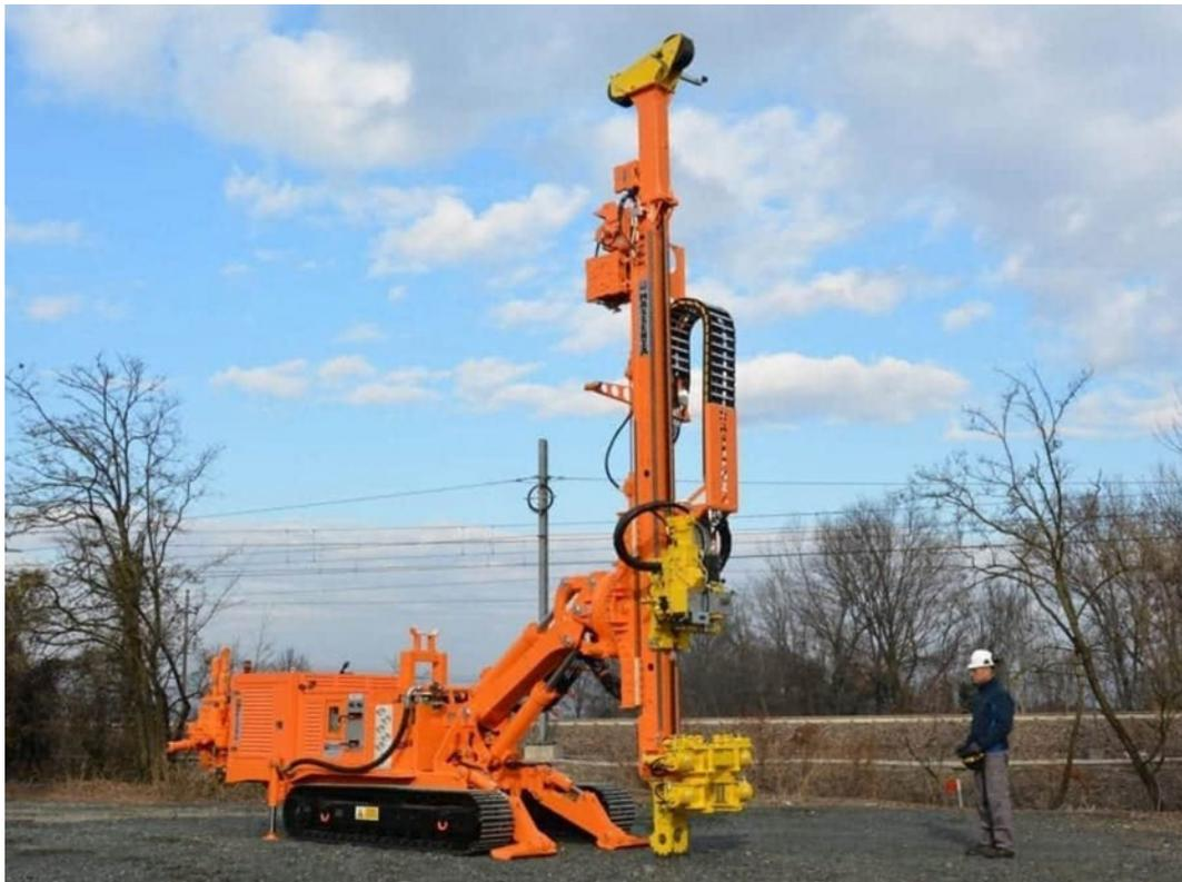
Figure 128 : Forage et mise en place de micropieux (Source : Web)
