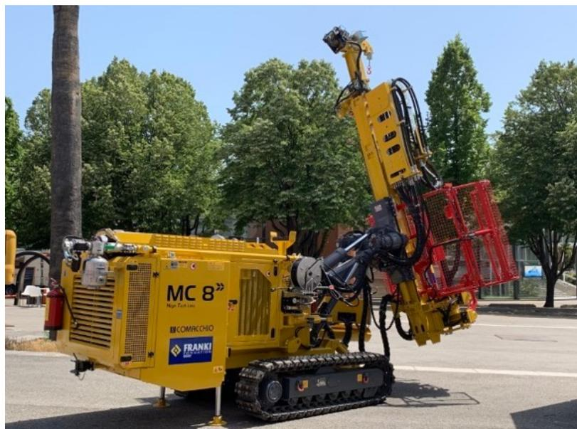
Figure 35 : Foreuse de type Comacchio MC8 de 8,8 Tonnes (Source Web)
