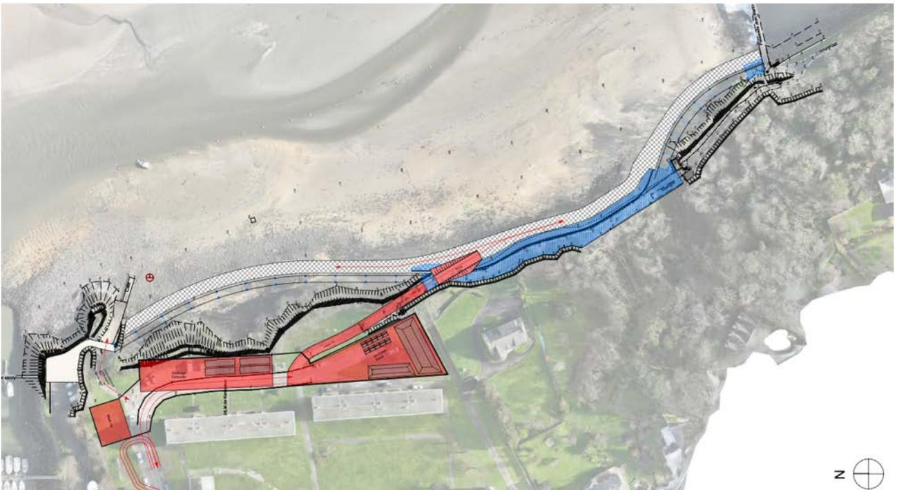
Figure 15 : Plan d'organisation de la zone de travaux (en rouge : installation de chantier et accès sécurisé, en bleu zone du perré à remblayer, en hachuré : zone de circulation des engins sur l'estran) (Source Atelier Confluence)
