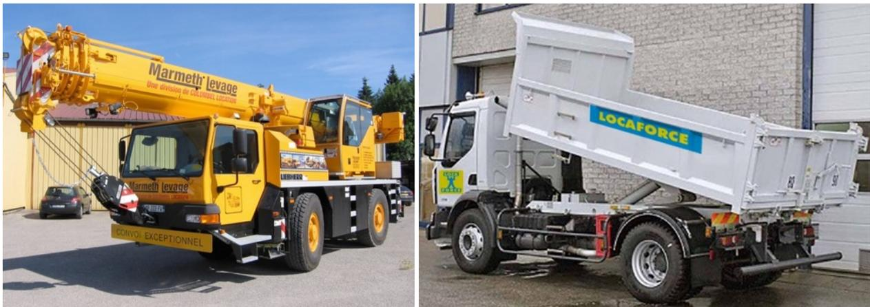
Figure 37 : Camion-grue de 35 T et camion-benne de 16 T (Source web)
