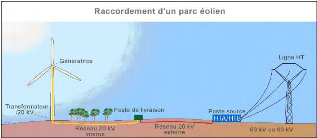
Figure 3 : Organisation générale du raccordement électrique au réseau de distribution (Source : ENCIS Environnement)
