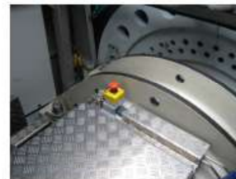
Illustration 15-3 : Bouton d'arrêt d'urgence situé sur le logement du roulement principal.
