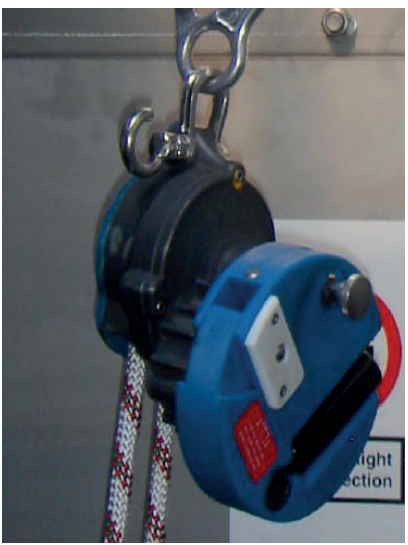
Utiliser le volant pour se soulever.
