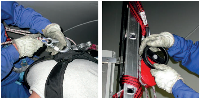
Attacher le mousqueton à l'anneau. Tourner le volant pour hisser le blessé.
