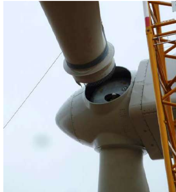
Photographie 26 : Fixation de la pale au moyeu
