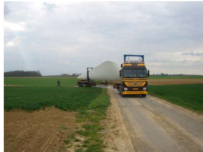
Photographie 17 : Transport d'une pale de 40 m
