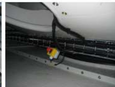
Illustration 15-4 : Bouton d'arrêt d'urgence situé au niveau de l'avant de la nacelle, en bas.
