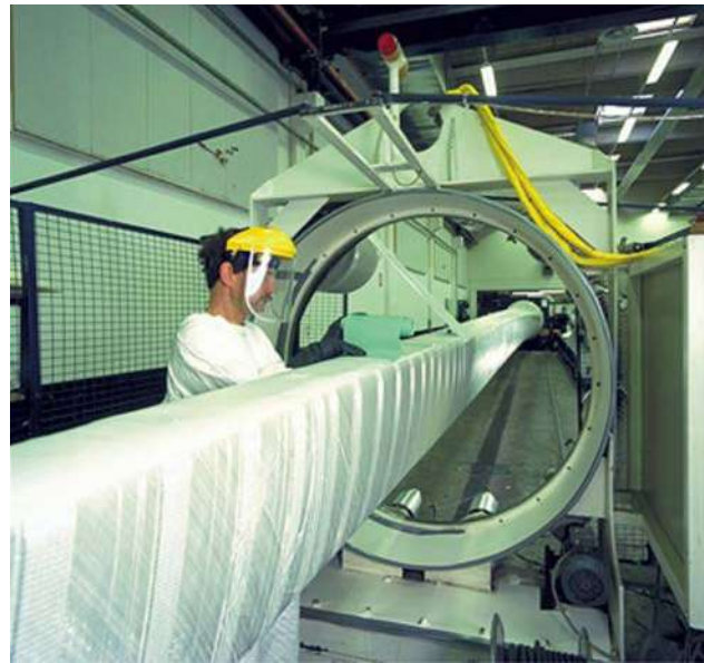
Photographie 23 : Fabrication de la poutre principale
