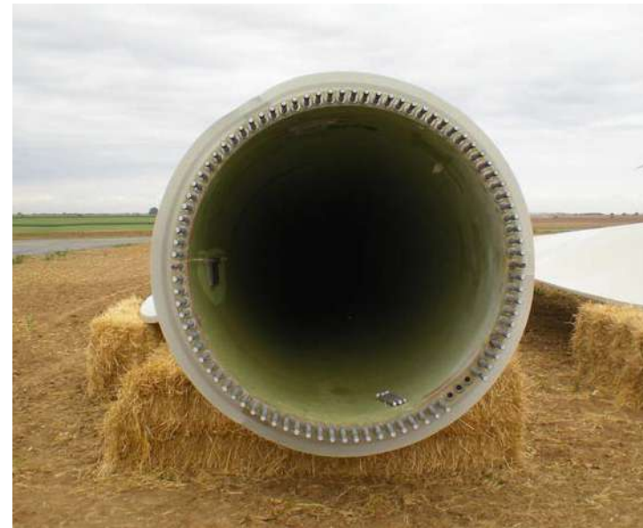
Photographie 25 : Goujons insérés dans les fourreaux, à la base de la pale
