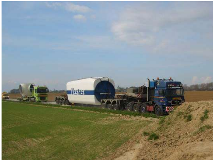
Photographie 14 : Transport du moyeu et de la nacelle
