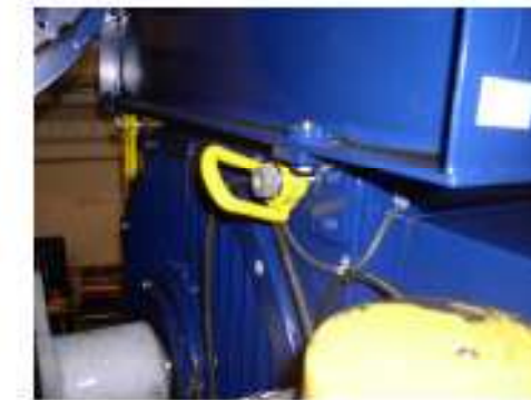
Illustration 22-1 : Points d'ancrage situés à l'avant du générateur.
