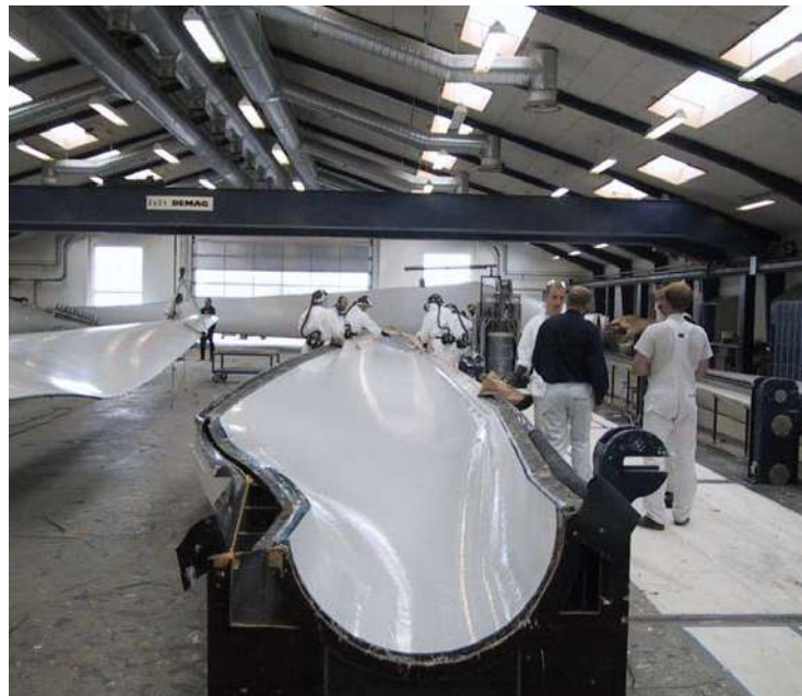
Photographie 24 : Fabrication d'une demi-coque
