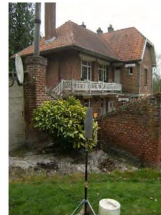
Emplacement du microphone pour la mesure au point n°4
