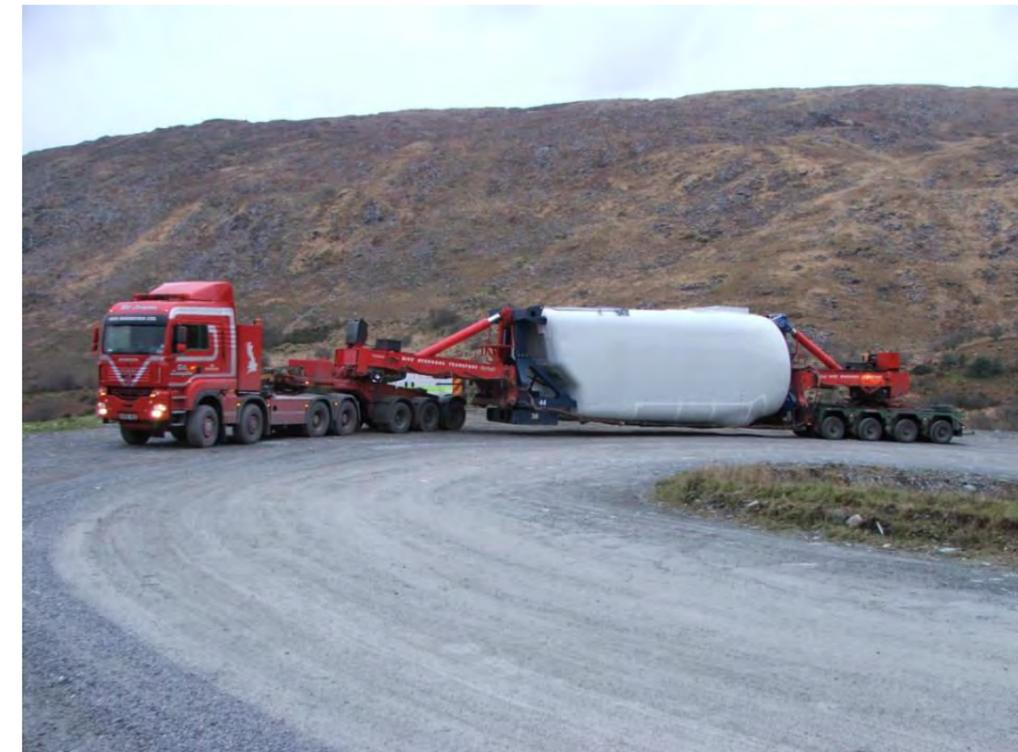
Figure 7 : illustration d'un rayon de courbure acceptable pour les 3MW V90
