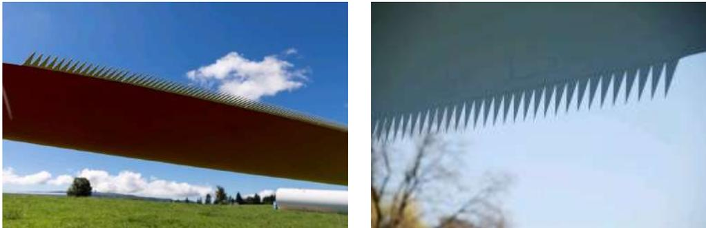
*Photographies d'une pale dotée d'un système STE (peigne / dentelure)*
