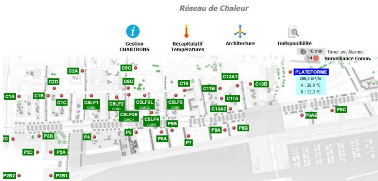
Image-écran de supervision d'un réseau de chaleur
